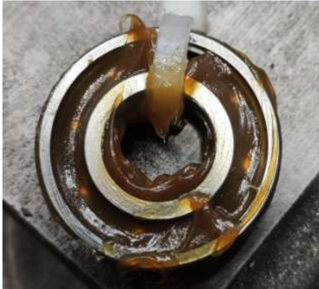
Εικόνα 8 - Ρουλεμάν με υπερτροφοδοσία γράσου
