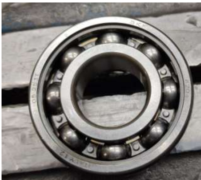
Εικόνα 7- Ρουλεμάν με έλλειψη γράσου
