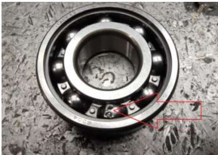
Εικόνα 9 - Ρουλεμάν με τραυματισμό των εσωτερικών σφαιρών του ρουλεμάν
