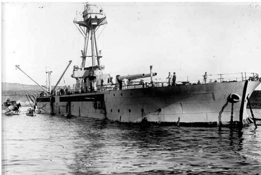
Το μόνιτορ «Raglan» με το υδροπλάνο Short το οποίο διόρθωνε τις βολές των πυροβόλων του το 1916. Τα δύο τεράστια πυροβόλα BL 14-inch Mark II (14 ιντσών/320 χιλιοστών) είχαν βεληνεκές σχεδόν 30 χιλιομέτρων και ήταν τα μεγαλύτερα τα οποία έβαλλαν κατά των Βουλγάρων και Τούρκων (Gallica N6946633).
