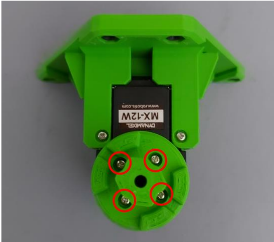
Figure 18: Στερέωση βάσης τροχού στον κινητήρα
