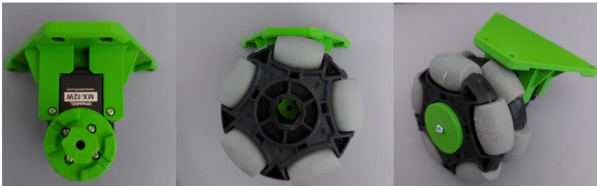
Figure 32: Τοποθέτηση τροχών κίνησης
