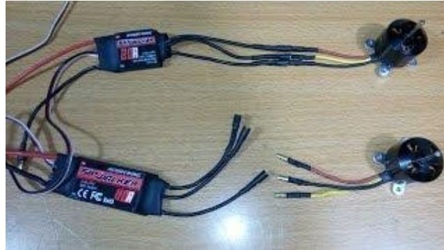
Εικόνα 26: Τα μοτέρ και οι ελεγκτές ταχύτητας με τους ακροδέκτες μπανάνα για ευκολότερη σύνδεση μεταξύ τους.
