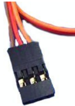
Εικόνα 29: Σύνδεση Dupont 3p
