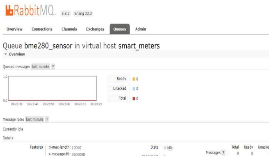
Εικόνα 77 Μεταφορά μετρήσεων για το μετρητή περιβάλλοντος BME280 στο RabbitMQ
