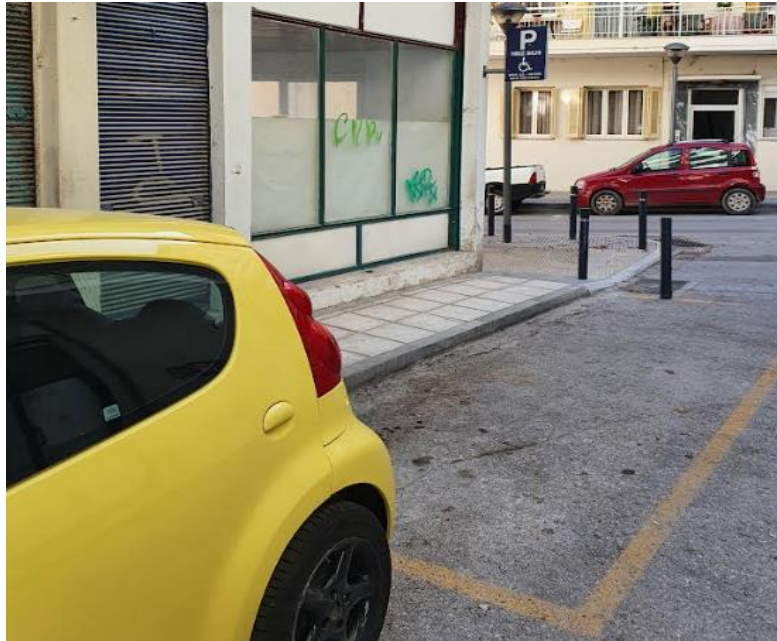
Εικόνα 33 Θέση Στάθμευσης ΑμεΑ χωρίς ράμπα και με σταθερό αστικό εμπόδιο
