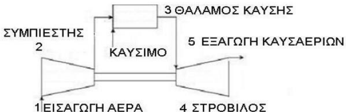
Εικόνα 44: Σχηματική θεωρητική απεικόνιση των μερών λειτουργίας του αεριοστρόβιλου. [Πηγή: http://www.pi-schools.gr/download/lessons/tee/mechanical/1b/kin_aeroskafon_1/kef_2a.pdf ]
