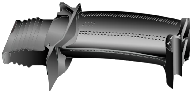
Εικόνα 13: Μια σχηματική απεικόνιση ενός πτερυγίου στροβίλου υψηλής πίεσης όπως χρησιμοποιείται σε κινητήρες αεριοθωμένων αεροσκαφών. Ένα εσωτερικό σύστημα ψύξης επιτρέπει μια διαβάθμιση θερμοκρασίας στα τοιχώματα της λεπίδας. Οι οπές ψύξης επιτρέπουν την έξοδο του αέρα ψύξης και καλύπτουν την εξωτερική επιφάνεια της λεπίδας με μια μεμβράνη ψύξης. [Πηγή: https://en.wikipedia.org/wiki/Turbine_blade#/media/File:GaTurbineBlade.svg ]
