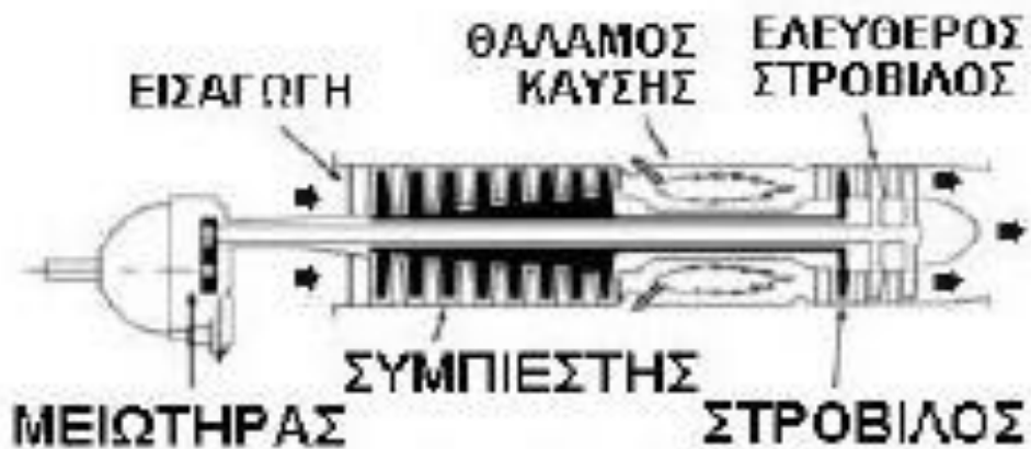
Εικόνα 25: Σχηματική απεικόνιση των βασικών μερών λειτουργίας του ελικοστρόβιλου. [Πηγή: http://www.pi-schools.gr/download/lessons/tee/mechanical/1b/kin_aeroskafon_1/kef_2a.pdf ]
