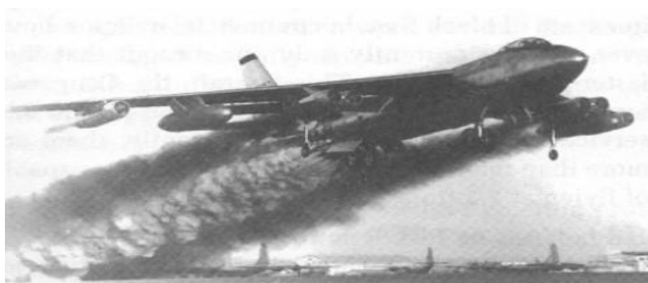
Εικόνα 19: Απεικόνιση αεροσκάφους στην φάση της απογείωσης ο οποίος χρησιμοποιεί πυραύλους στερεών καυσίμων. [Πηγή: http://www.pi-schools.gr/download/lessons/tee/mechanical/1b/kin_aeroskafon_1/kef_2a.pdf ]
