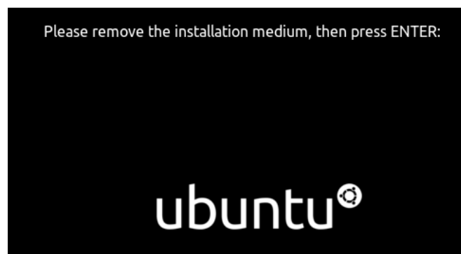
Εικόνα Γ.12: Το δέκατο και τελευταίο βήμα της εγκατάστασης του Ubuntu στον υπολογιστή, όπου αφαιρούμε το USB Flash Drive από τον υπολογιστή και πατάμε το πλήκτρο Enter για να γίνει η επανεκκίνηση.
