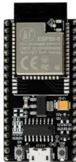
Εικόνα 5.2 ESP32-S Ο μικροελεγκτής που απαρτίζει την τελική και την κεντρική συσκευή.
