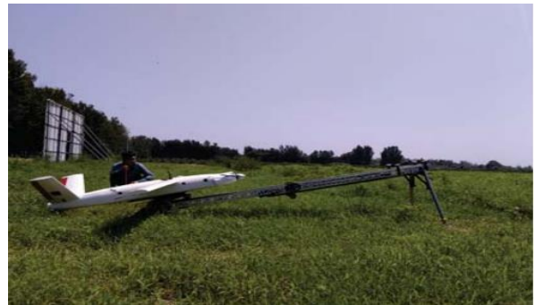
Εικ. 2.10: Σύστημα εκτόξευσης Fixed-wing
