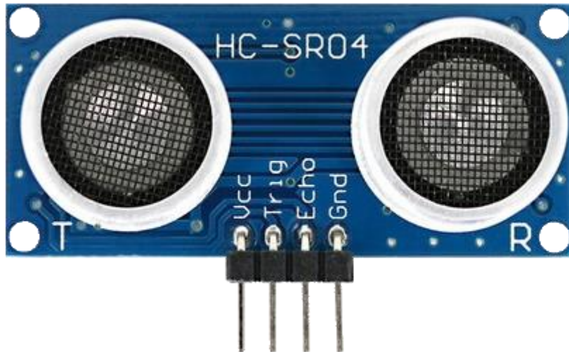
Εικόνα 9: Αποστασιόμετρο HC-SR04 (πηγή: https://www.why.gr/ )
