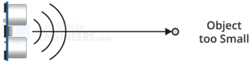
Εικόνα 13: Το αντικείμενο είναι πολύ μικρό για να μπορέσει να αντανακλάσει τον ήχο του αποστασιόμετρου (πηγή: Last Minute Engineers)
