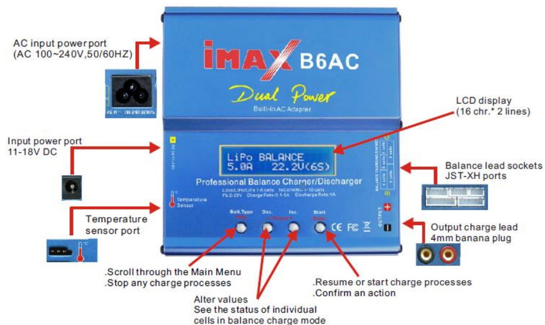
Εικόνα 39: Επεξήγηση μερών του φορτιστή μπαταριών iMAX B6AC με ετικέτες (πηγή: Pololu)
