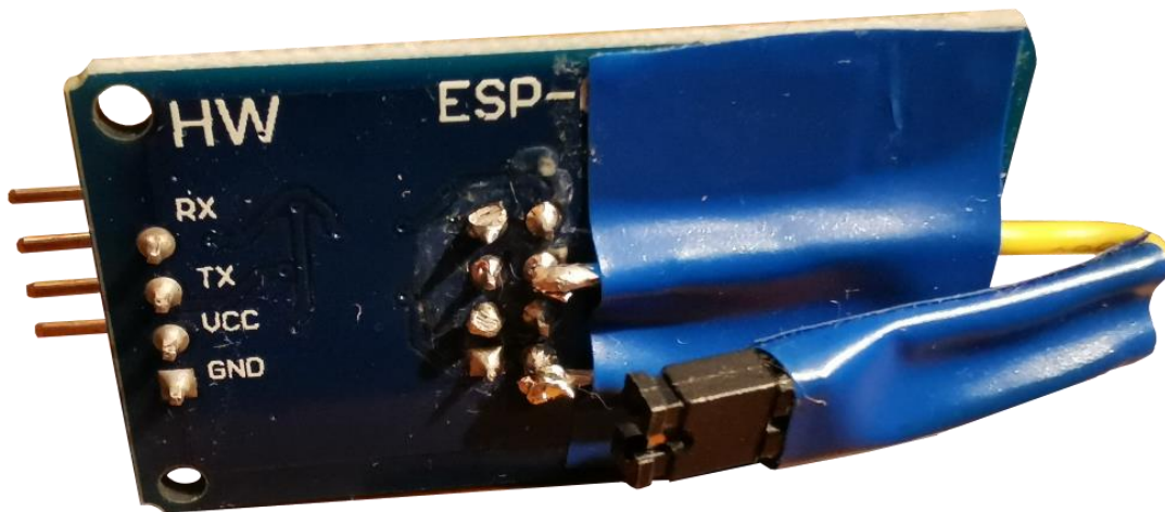
Εικόνα 5: Προγραμματισμός ESP-01S με προσαρμογέα ESP-01 και ένωση των ακίδων GND με GPIO0
