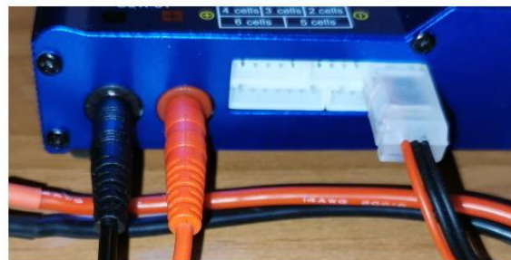
Εικόνα 40: Συνδεσμολογία φορτιστή μπαταριών iMAX B6AC με μπαταρία λιθίου Gens Ace
