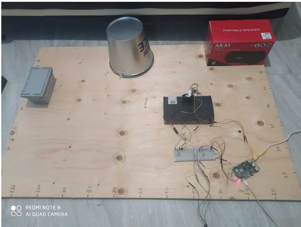
Εικόνα 4.19 Δοκιμή κατασκευής με Lidar sensor στην δεύτερη θέση ( x=40 , y=40 )
