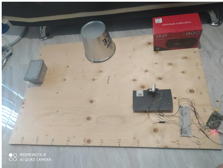
Εικόνα 4.11 Δοκιμή κατασκευής Ultrasonic sensor στην πρώτη θέση (x=30, y=30)
