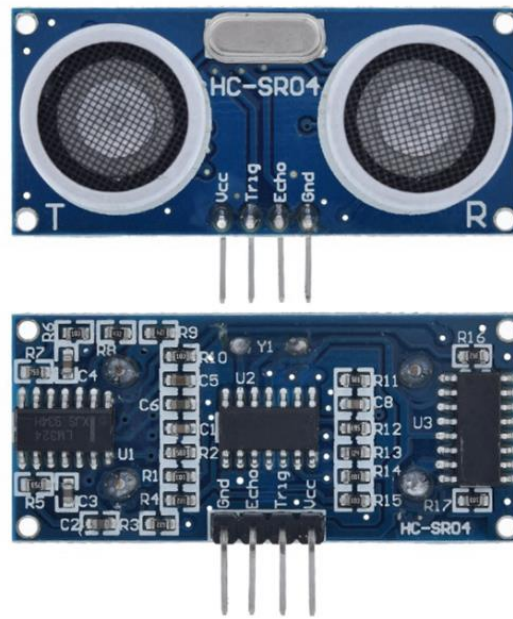
Εικόνα 4.3 Μπροστά και πίσω όψη αισθητήρα υπερήχων HC-SR04
