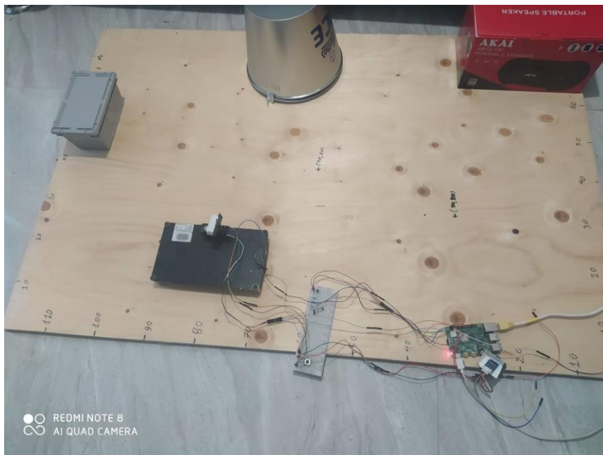
Εικόνα 4.15 Δοκιμή κατασκευής με Ultrasonic sensor στην τρίτη θέση ( x=20 , y=80 )
