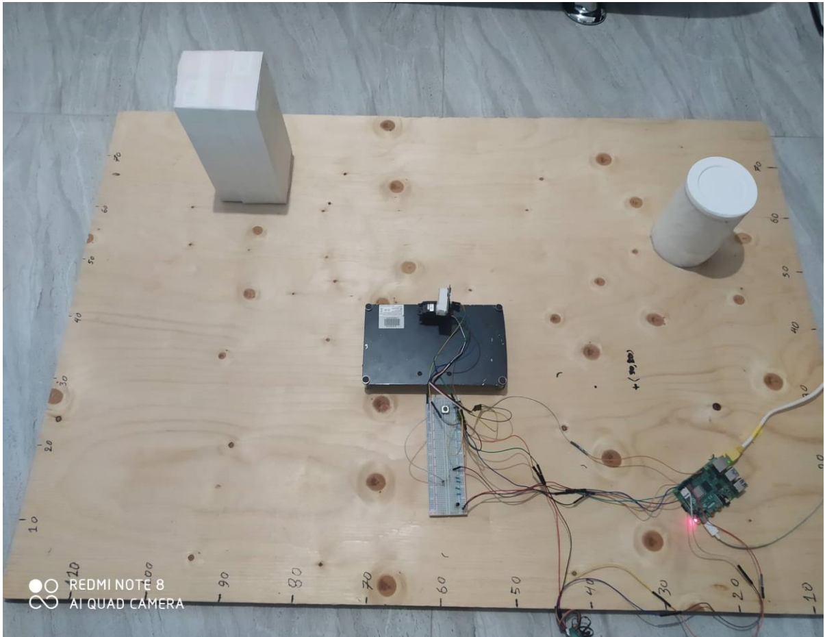
Εικόνα 4.23 Δοκιμή κατασκευής Ultrasonic sensor στην πρώτη θέση ( x=40 , y=60 )
