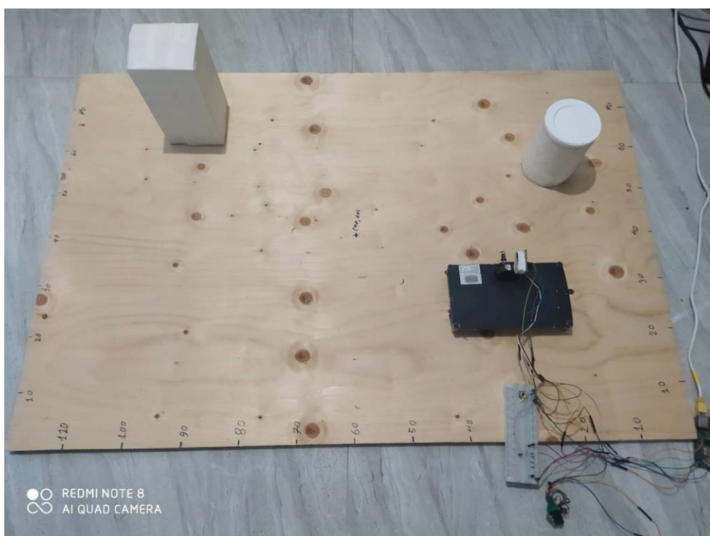
Εικόνα 4.25 Δοκιμή κατασκευής με Ultrasonic sensor στην δεύτερη θέση ( x=30, y=30 )
