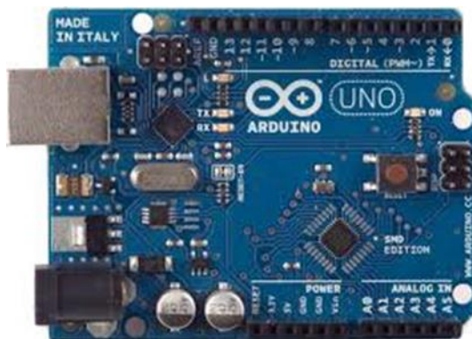
Εικόνα 2.2 Μικροϋπολογιστής Arduino Uno
