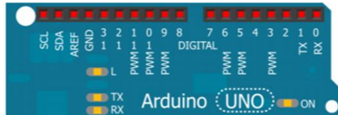
Εικόνα 2.11 Οι ψηφιακοί ακροδέκτες του Arduino
