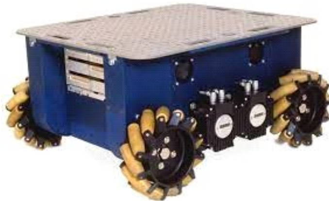
Εικόνα 12. Uranus παν-κατευθυντικό κινητό ρομπότ με τροχούς Mecanum. [2]
