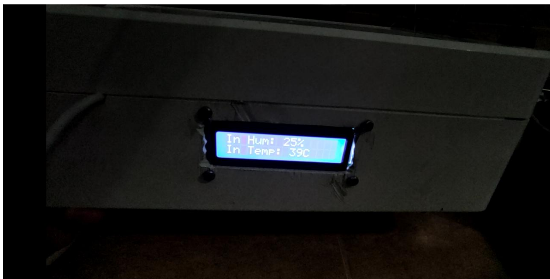
Εικόνα 76: Εμφάνιση εσωτερικής υγρασίας και θερμοκρασίας
