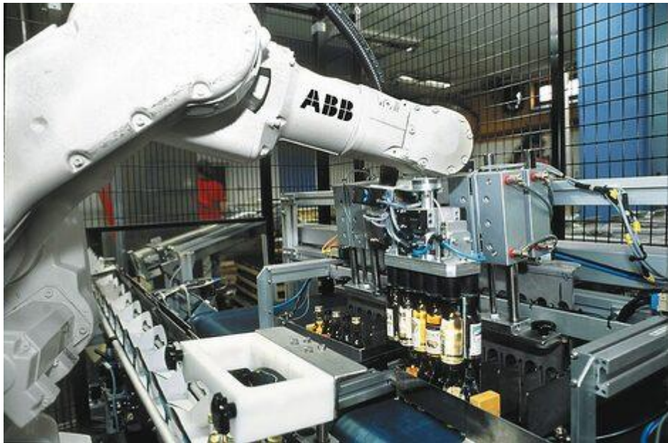
Εικόνα 6 Ρομποτικός Βραχίονας της Εταιρίας ABB, σε γραμμή εμφιαλώσεως.
