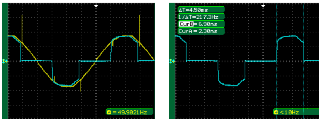
a) Δημιουργία τάσης 160Vrms εφαρμόζοντας τον κανόνα 254. b) Μέτρηση της αγωγής του διακόπτη σειράς.
