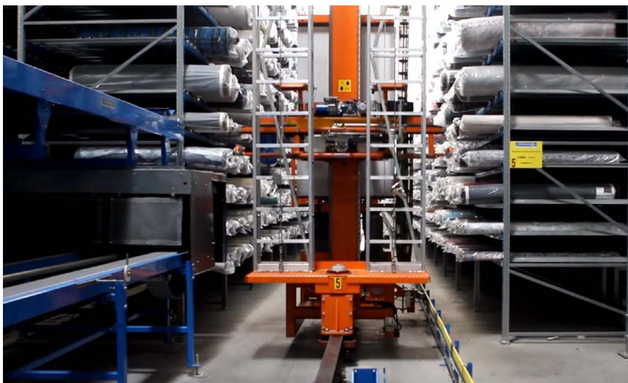
Εικόνα 2.3 - Stacker Crane μεταφοράς ρολών
