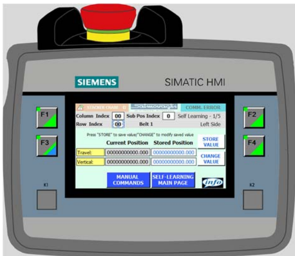
Εικόνα 7.4 – Αποθήκευση ή αλλαγή τιμών θέσης (0,0,0) αυτόματης εκμάθησης στην αριστερή πλευρά της αποθήκης
