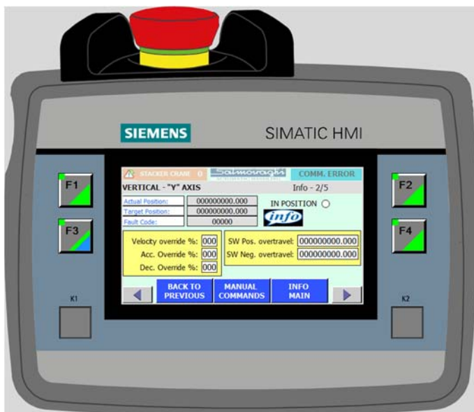
Εικόνα 7.15 – Τρέχουσα θέση άξονα Y και όρια min/max που μπορεί να κινηθεί καθώς και ποσοστά ταχύτητας και επιτάχυνσης
