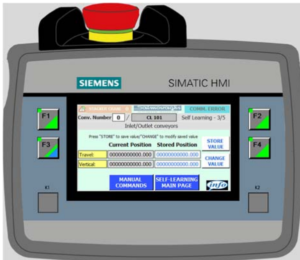
Εικόνα 7.6 – Αποθήκευση ή αλλαγή τιμών θέσης αυτόματης εκμάθησης στους διαδρόμους εισαγωγής/εξαγωγής προϊόντων
