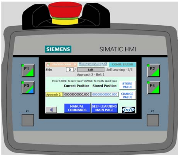
Εικόνα 7.8 – Αποθήκευση ή αλλαγή τιμών θέσης αυτόματης εκμάθησης στους άξονες Z3
