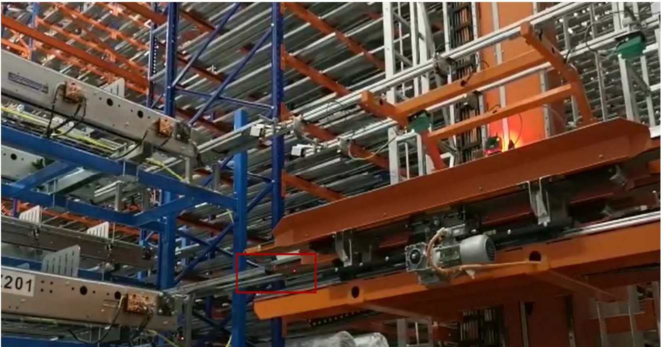
Εικόνα 6.11 – Μηχανή έτοιμη σε θέση για εκφόρτωση στους διαδρόμους μεταφοράς. Έπειτα το φορτίο φεύγει από την αποθήκη
