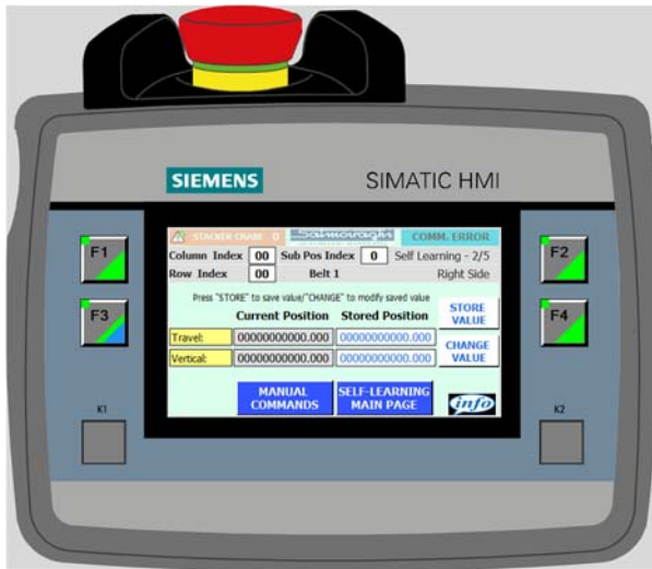
Εικόνα 7.5 – Αποθήκευση ή αλλαγή τιμών θέσης αυτόματης εκμάθησης (0,0,0) της στη δεξιά πλευρά της αποθήκης
