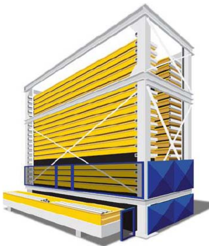
Εικόνα 4.5 - Μονάδα κατακόρυφης ανύψωσης με δύο σειρές δίσκων αποθήκευσης, έναν άξονα στη μέση και μια περιοχή συλλογής μπροστά (Εικόνα της κάθετης μονάδας ανύψωσης, 2016).
