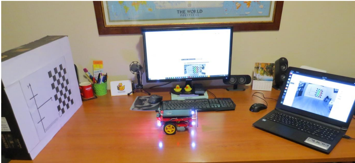
Εικόνα 138 : Στιγμιότυπο από τη διαδικασία βαθμονόμησης των ενδογενών παραμέτρων της κάμερας του Duckiebot Στο laptop αναδύεται ένα παράθυρο όπως αυτό της παρακάτω εικόνας
