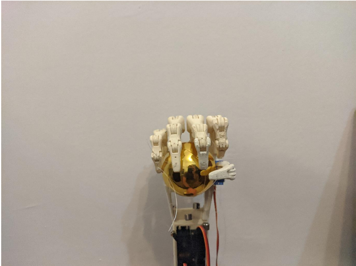
Εικόνα 42: Δυνατότητα συγκράτησης αντικειμένου (μπάλας), του ρομποτικού χεριού, αποδεικνύοντας την εύρυθμη λειτουργία του.
