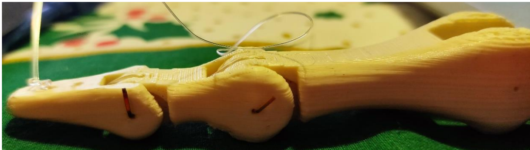
Εικόνα 33: Απεικόνιση τελικής συναρμολόγησης ενός δακτύλου ενδεικτικά.
