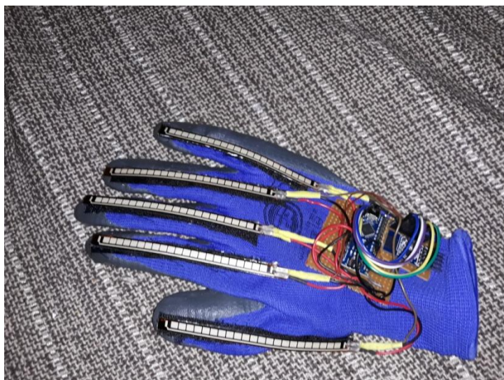
Εικόνα 31: Το απτικό γάντι με ενσωματωμένα τους αισθητήρες κάμψης, τον μικροελεγκτή και το Bluetooth module
