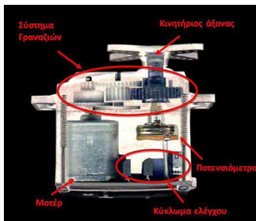
Εικόνα 18: Εσωτερική απεικόνιση σερβοκινητήρα
