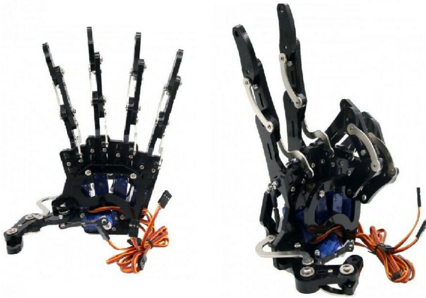
Εικόνα 16: Ρομποτικό χέρι 5 βαθμών ελευθερίας
