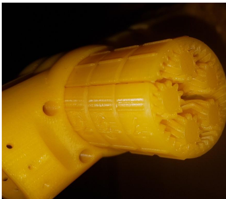
Εικόνα 4.9 Τοποθέτηση μειωτήρα 66:1 στον σύνδεσμο
