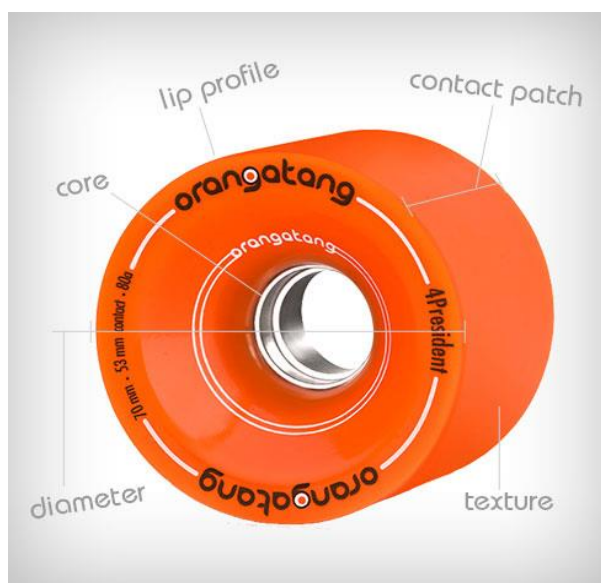
Εικόνα 1.12 Χαρακτηριστικά τροχού
