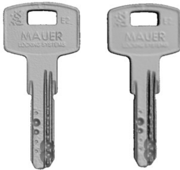
Εικόνα 15. Αριστερά: ανάλυση 0.15mm, δεξιά: ανάλυση 0.3mm
