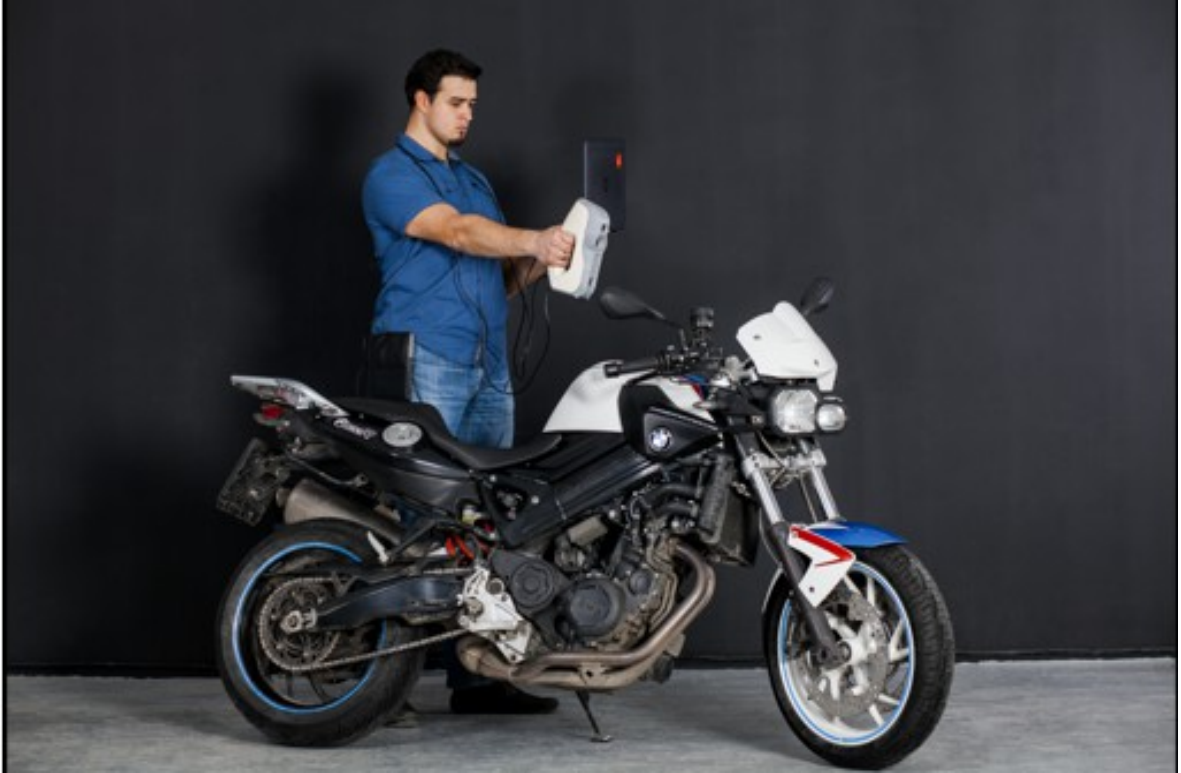
Εικόνα 17. Φορητός σαρωτής με μπαταρία για συνεχή λήψη δεδομένων 3D
