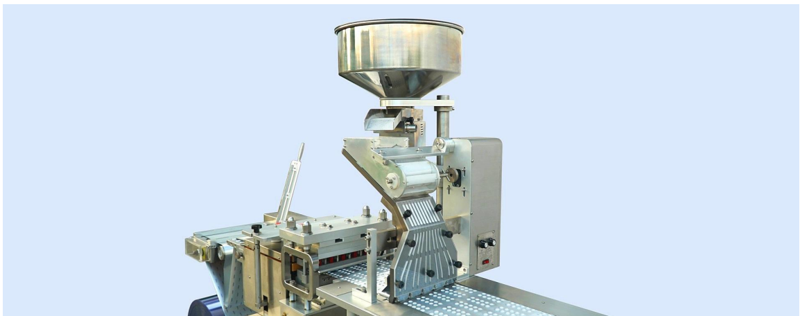
Εικόνα 2.1: Chute alu-alu Blister Feeder, πηγή: https://jornen.com/ Βλέπε αναφορά [7]
