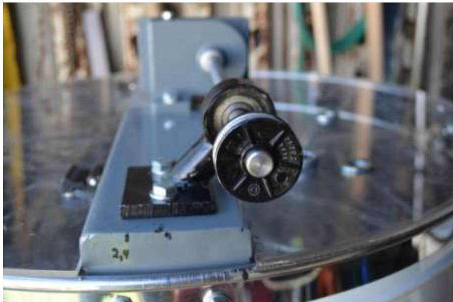
Εικόνα 7. Η τροχαλία που τοποθετήσαμε στη θέση της χειρολαβής, ίδιας διαμέτρου με αυτής του κινητήρα.
