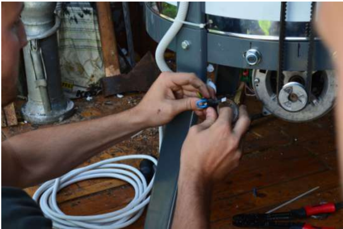
Εικόνα 10. Σύνδεση του κινητήρα
