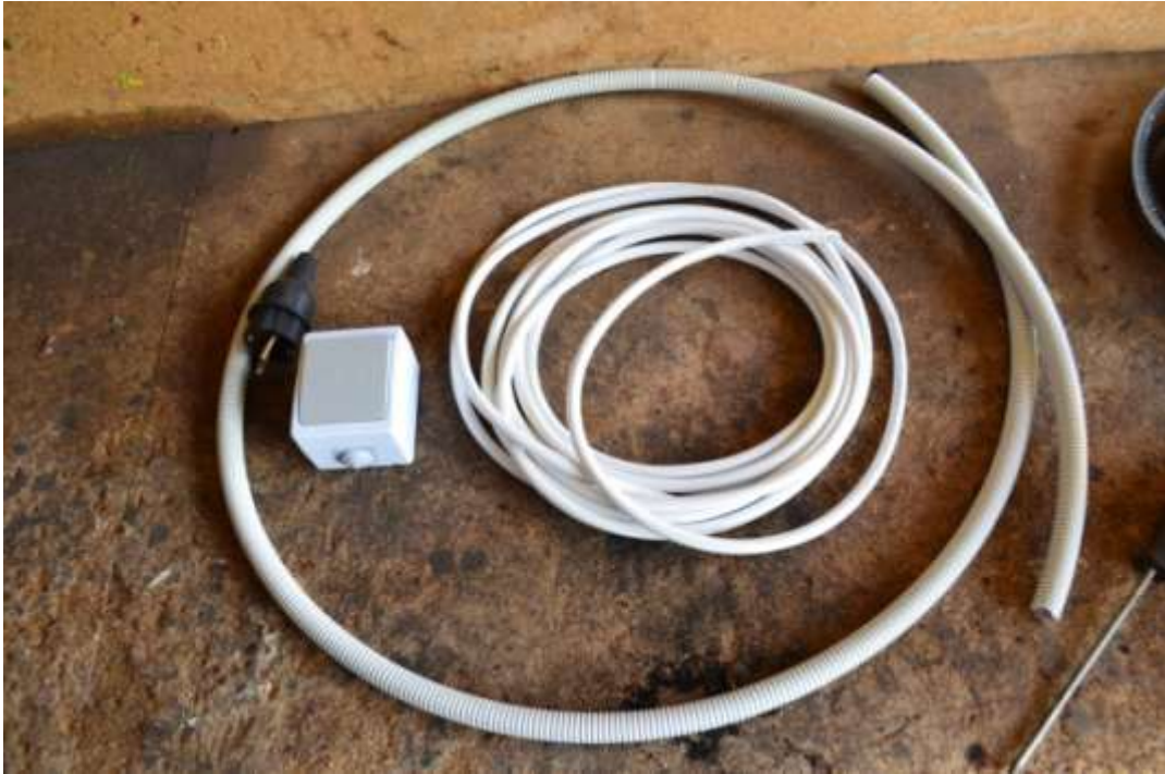
Εικόνα 9. α) αρσενικό φινις σούκο β) καλώδιο γ) εξωτερικός διακόπτης
