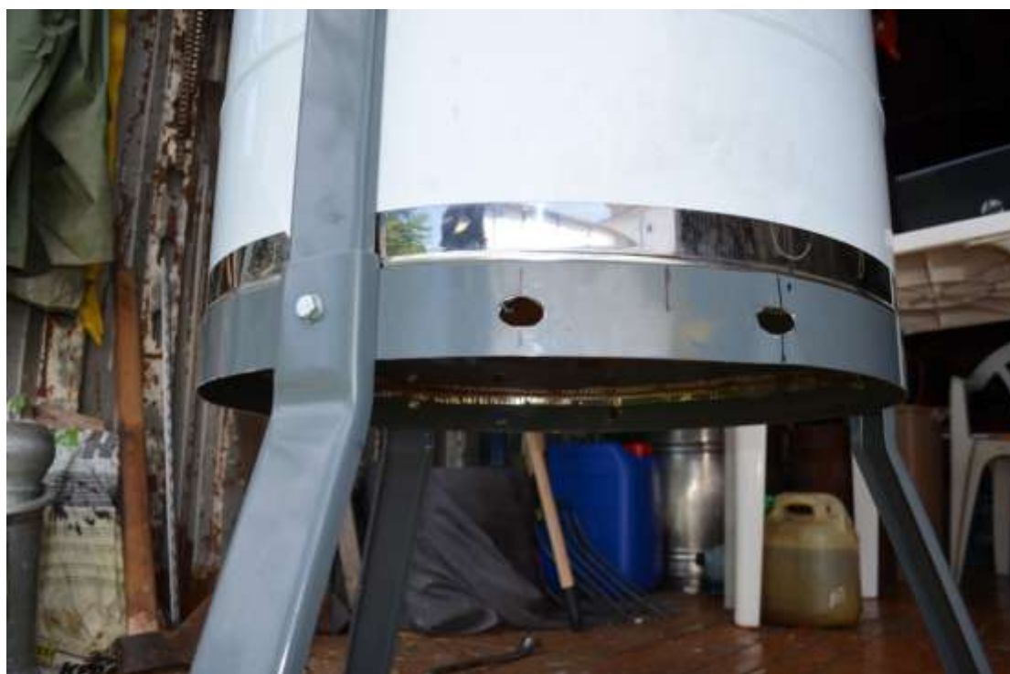
Εικόνα 4. Τρύπες για να περαστούν οι ολόπασες βέργες και να κρεμαστεί ο κινητήρας πάνω σ'αυτές.
