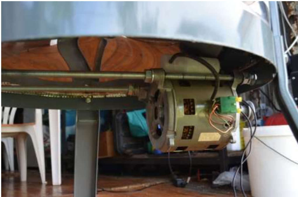
Εικόνα 5. Στερέωση του κινητήρα με τη χρήση ολόπασων βεργών.
