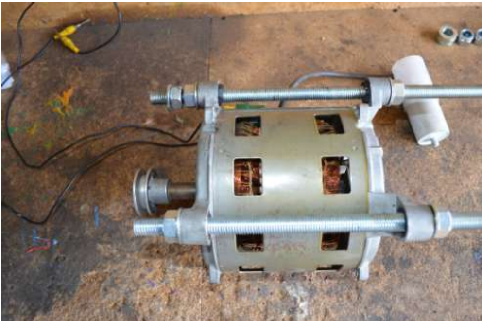
Εικόνα 3. Κινητήρας από πλυντήριο ρούχων 300 rpm.
