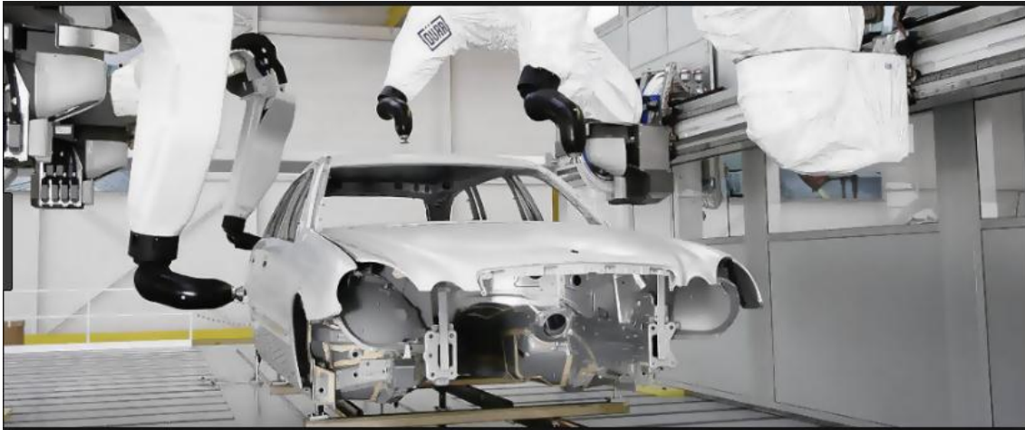
Εικόνα 1.2. Χρήση ρομποτικών βραχιόνων-φανοποιών για βαφή αυτοκινήτων
