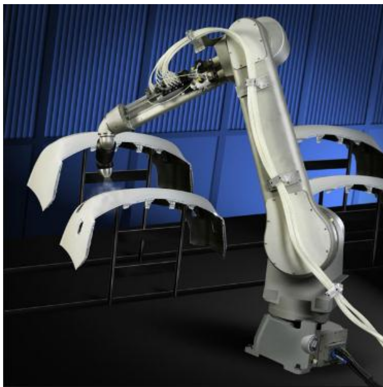
Εικ 2.36 Ρομποτικός βραχίονας σε κάποιο φανοποιείο κατά την εκτέλεση εργασίας βαφής
