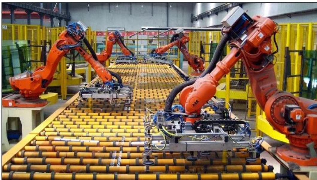
Εικ 2.37 Ρομποτικοί βραχίονες σε γραμμή παραγωγής κατά την εκτέλεση εργασιών παλετοποίησης
