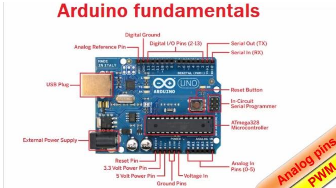
Εικόνα 5.4 Περιγραφή των μερών της πλακέτας Arduino Uno
