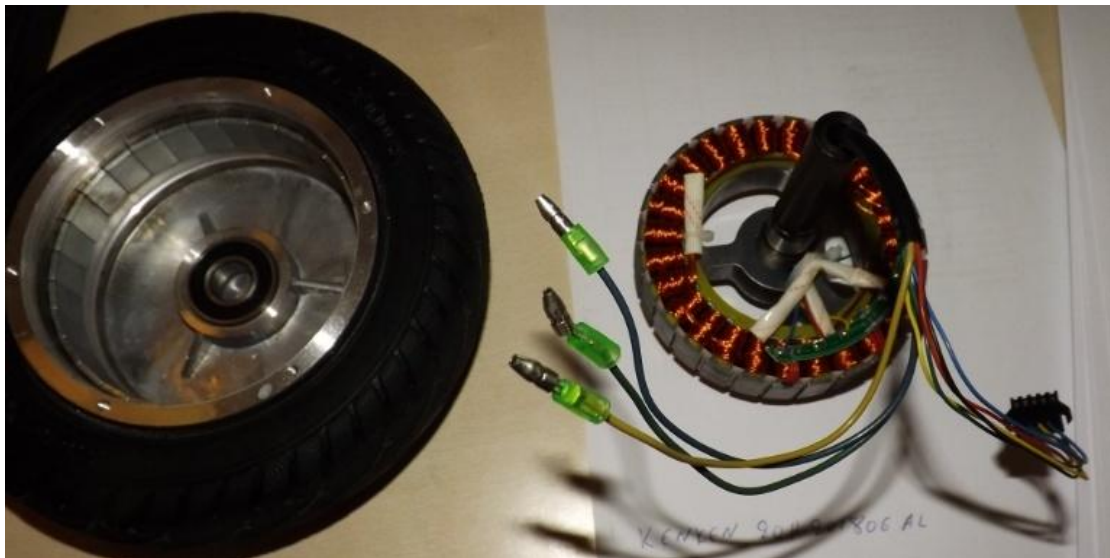
Εικόνα 26 Ρότορας μόνιμων μαγνητών και Στάτης (πηνία) σε BLDC motor
