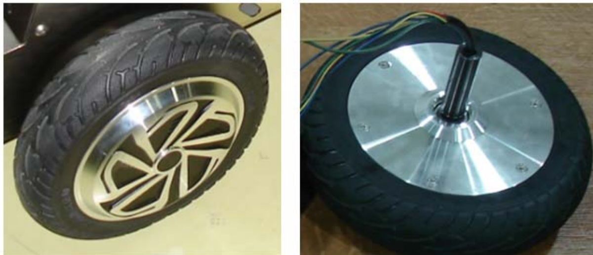
Εικόνα 44 Εικόνα των κινητήριων τροχών από δύο όψεις
