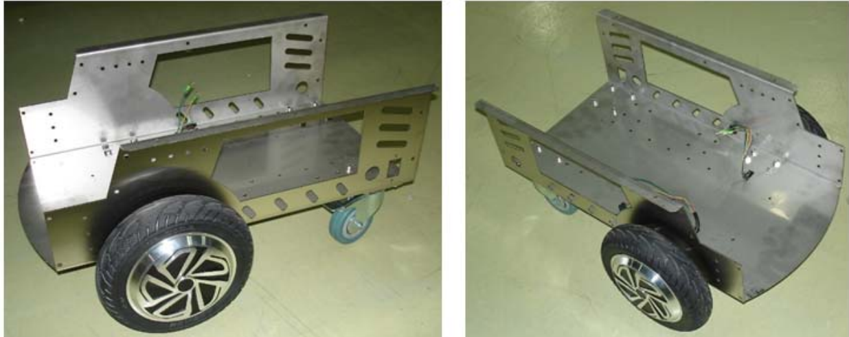
Εικόνα 41 Συναρμολόγηση των τροχών με την βάση του ρομπότ
