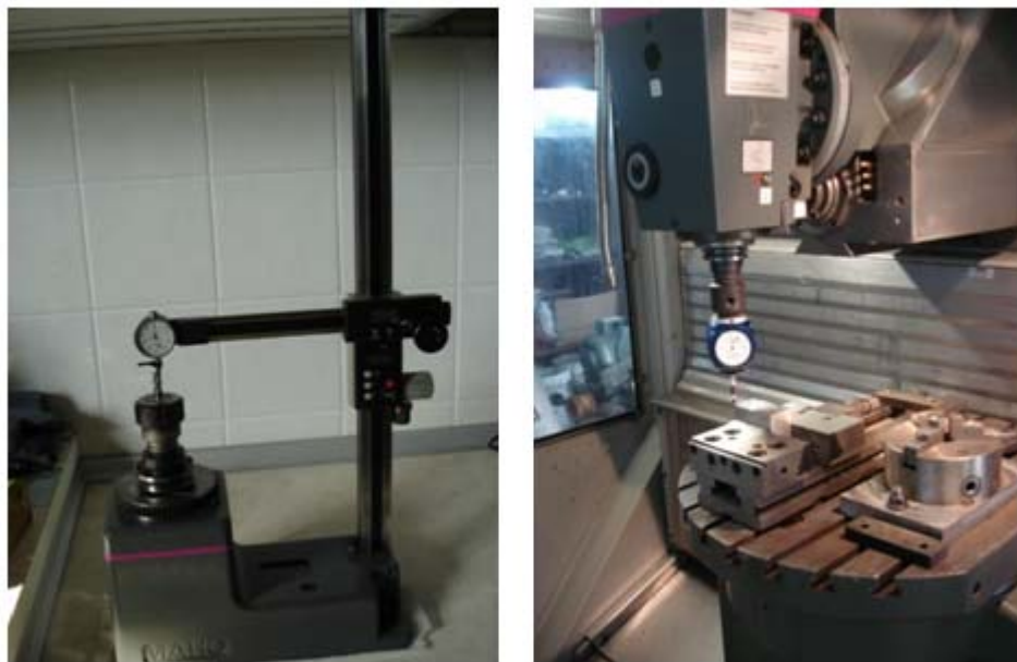
Εικόνα 37 Βασικές ρυθμίσεις της εργαλειομηχανής CNC
