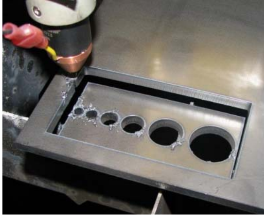
Εικόνα 22 Κατεργασία κοπής με πλάσμα
