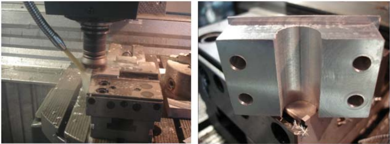
Εικόνα 38 Εικόνες από την κατεργασία της βάσης στήριξης των τροχών
