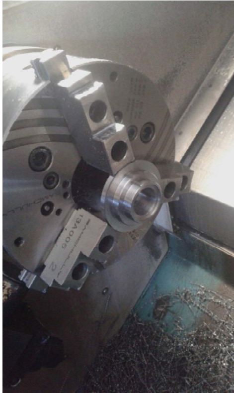
Εικόνα 23. Έναρξη κατεργασίας κοπής του νέου ζευγαριού της 5ης σχέσης στον CNC τόρνο.
