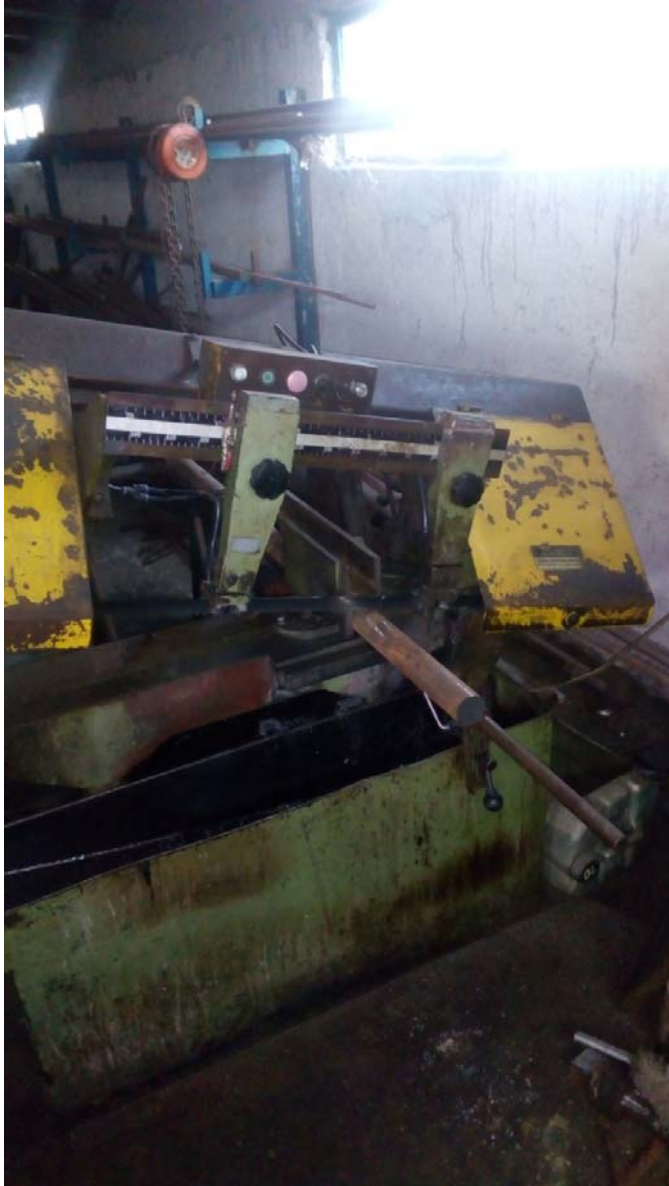
Εικόνα 17. Έναρξη κοπής νέων τεμαχίων στο αυτόματο πριόνι ως πρώτη ύλη για την κατασκευή νέων ζευγαριών οδοντωτών τροχών.
