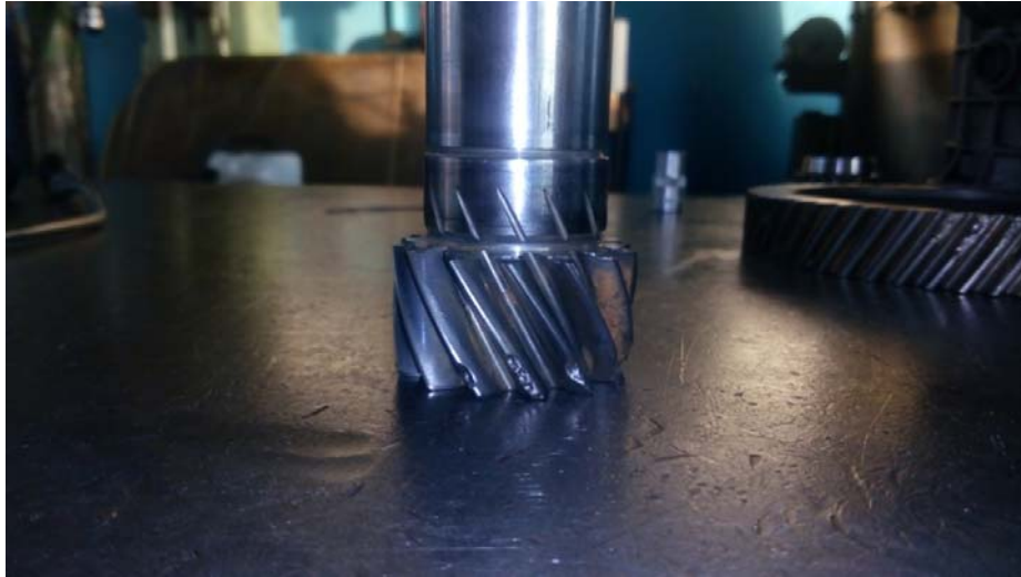
Εικόνα 16. Η αστοχία και η φθορά στο πινιόν.
