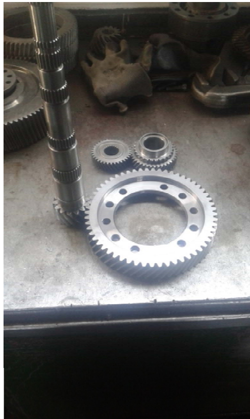
Εικόνα 38. Τελική μορφή των νέων τεμαχίων για το κιβώτιο.
