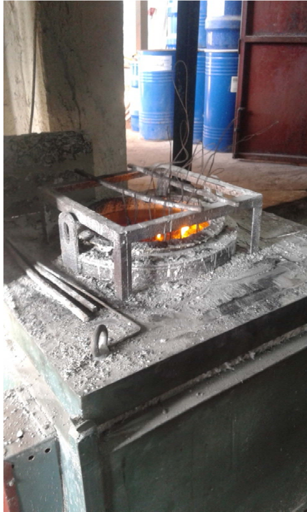
Εικόνα 40. Λουτρό κυανιούχων αλάτων.
