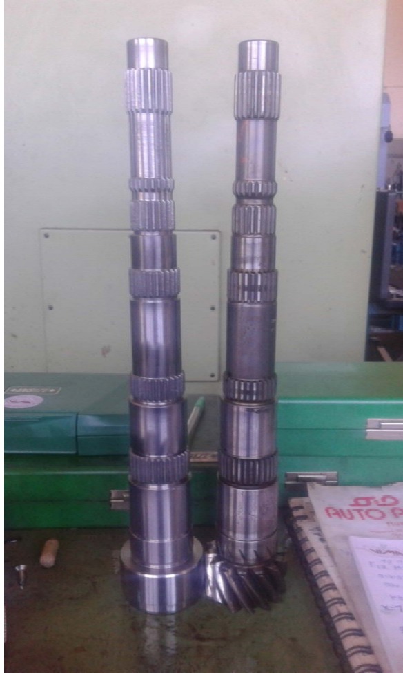
Εικόνα 29. Τελικό αποτέλεσμα του νέου πινιόν μετά την κοπή του πολύσφηνου.
