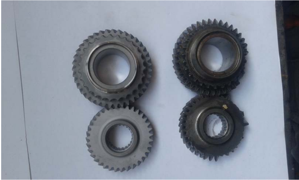
Εικόνα 52: Αποτελέσματα μετά από όλες τις κατεργασίες.
