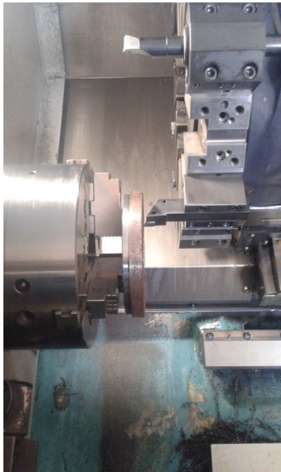
Εικόνα 21.Έναρξη κατεργασίας κοπής της νέας κορώνας στον CNC τόρνο.
