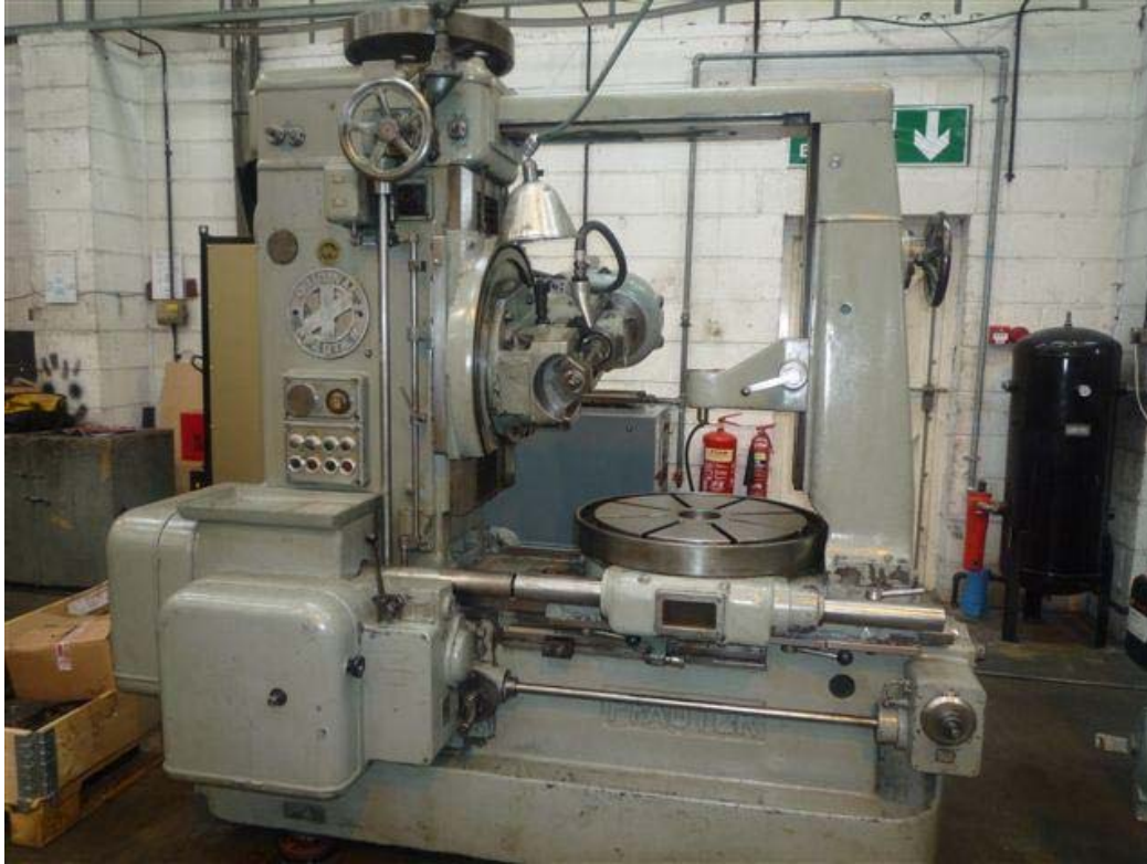
Εικόνα 31. Pfauter gear hobber.
