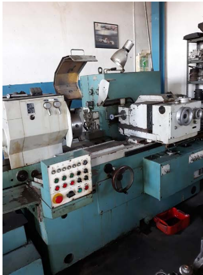
Εικόνα 49: Λειαντική μηχανή οπών.
