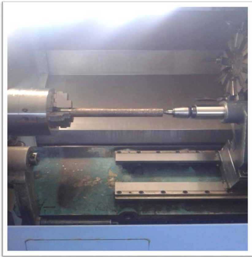
Εικόνα 18. Έναρξη κατεργασίας του νέου πινιόν στον CNC τόρνο.
