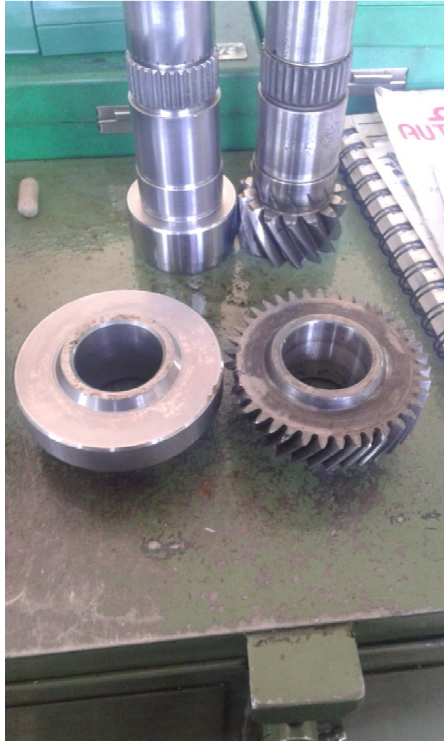
Εικόνα 24. Τελικό αποτέλεσμα του νέου οδοντωτού τροχού της 5ης σχέσης του κιβωτίου μετά από τη μορφοποίηση του στον CNC τόρνο.
