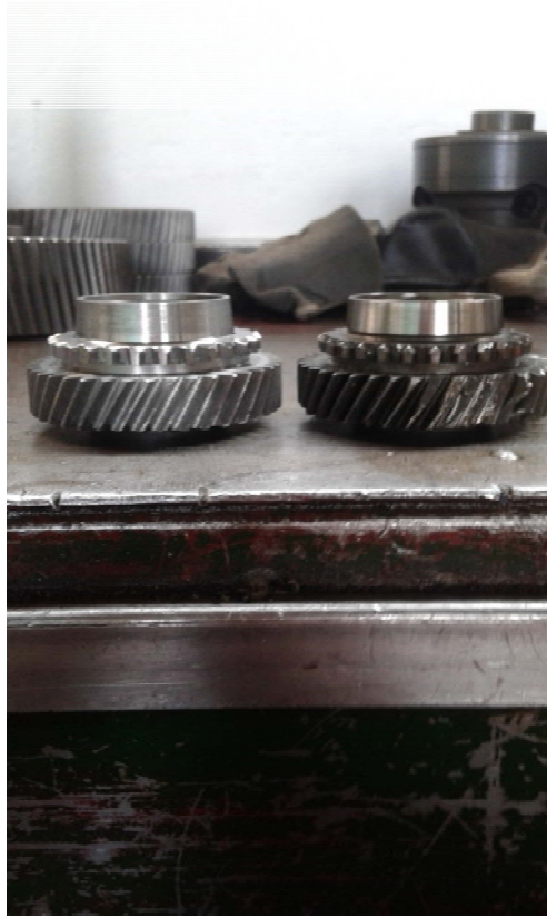
Εικόνα 37. Αποτέλεσμα του 2ου γρναζιού της 5ης σχέσης μετά από τις κατεργασίες κοπής οδόντωσης και κοπή οδόντωσης για το συγχρονιζέ της 5ης σχέσης.
