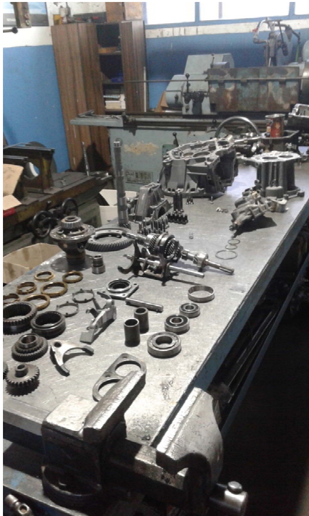
Εικόνα 53: Όλα τα εξαρτήματα του κιβωτίου έτοιμα για επανασυναρμολόγηση.
