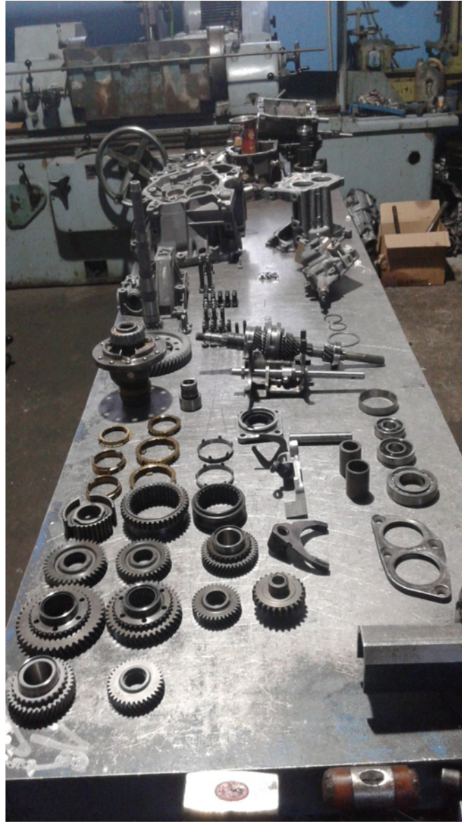
Εικόνα 54: Τεμάχια κιβωτίου προς συναρμολόγηση
