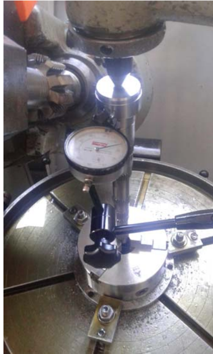
Εικόνα 30. Κοπή αριστερόστροφης οδόντωσης του νέου πινιόν.
