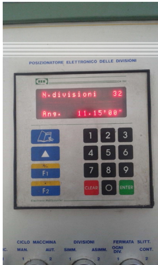
Εικόνα 28.Επιλογή αυτόματης διαίρεσης στο καντράν της NC μηχανής .
