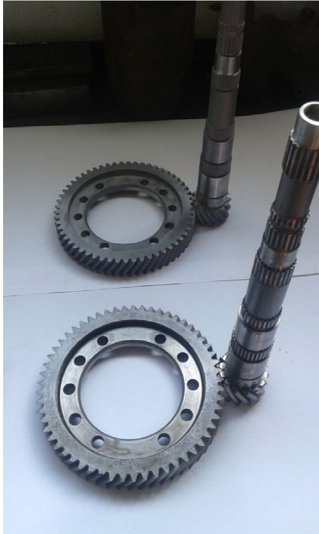
Εικόνα 44: Τα νέα τεμάχια του κιβωτίου μετά και από την θερμική τους κατεργασία.
