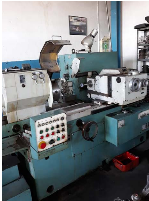
Εικόνα 5: Λειαντική μηχανή οπών.
