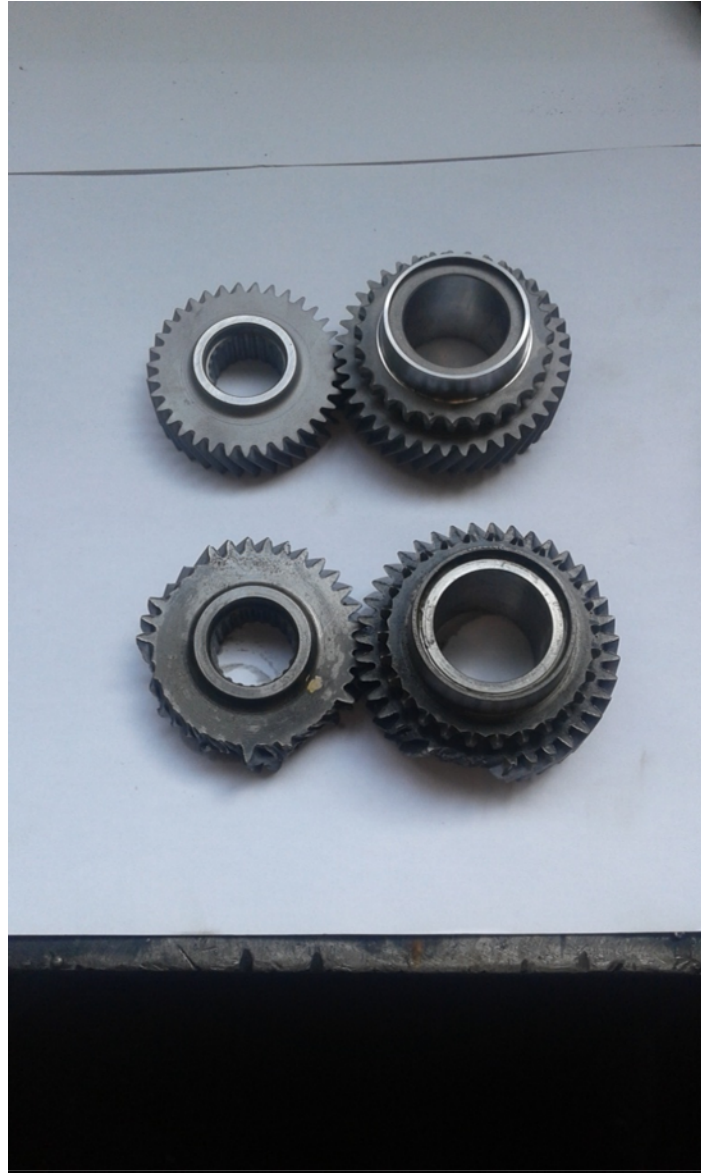
Εικόνα 43: Τα νέα τεμάχια του κιβωτίου μετά και από την θερμική τους κατεργασία.
