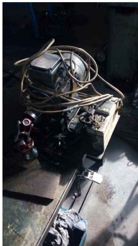
Εικόνα 56:Ειδικό χειροποίητο δοκιμαστήριο για κιβώτια ταχυτήτων.
