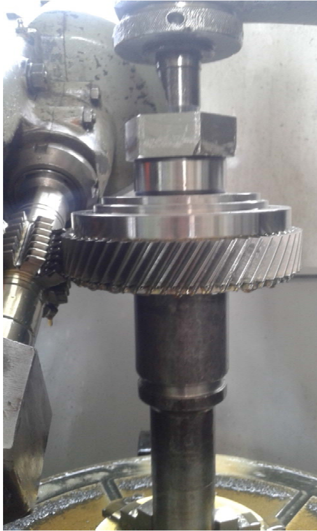
Εικόνα 33. Έναρξη κοπής οδόντωσης κορώνας στο γραναζοκόπτη.
