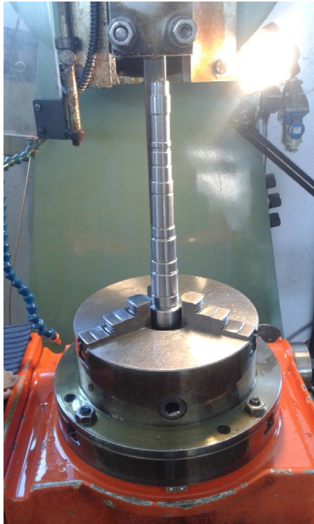
Εικόνα 27. Κοπή οδόντωσης (πολύσφηνο) του πινιόν.
