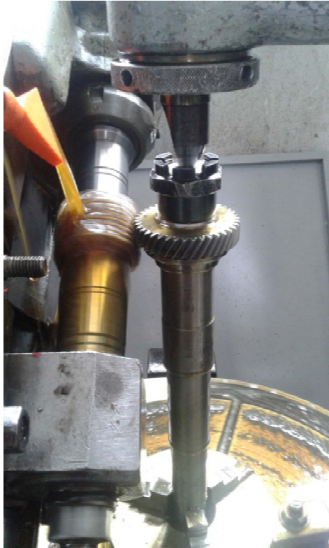
Εικόνα 35. Έναρξη κοπής οδόντωσης 1ου γραναζιού της 5ης σχέσης του κιβωτίου.
