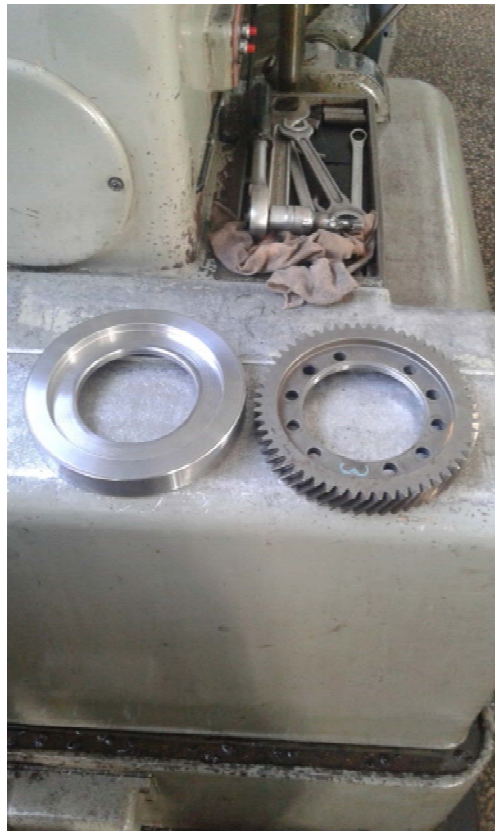
Εικόνα 22: Τελική μορφή κορώνας μετά τις κατεργασίες κοπής σε τόρνο
