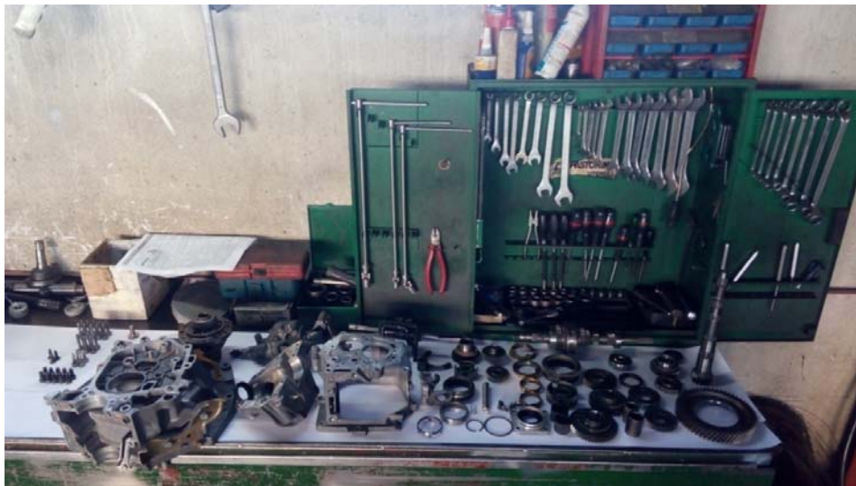
Εικόνα 14. Αποσυναρμολόγηση του κιβωτίου ταχυτήτων.
