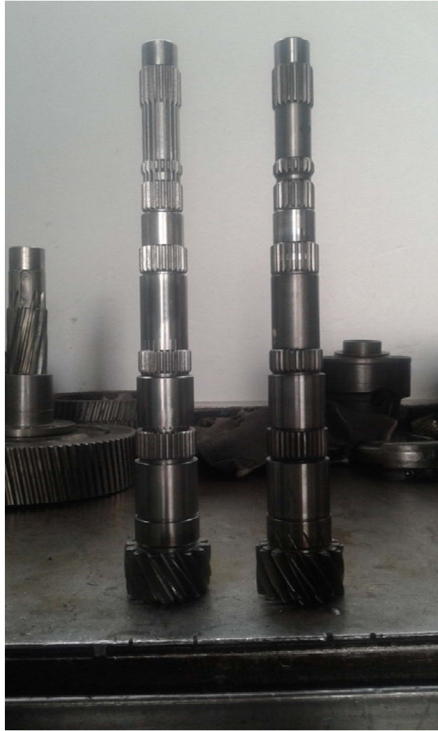
Εικόνα 32. Τέλος κατεργασιών για το νέο πινιόν .
