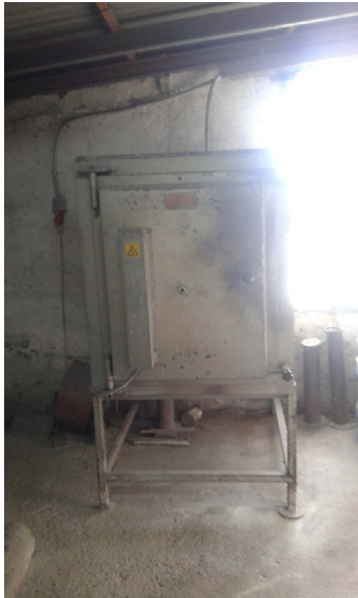
Εικόνα 39. Έναρξη θερμικής κατεργασίας στο φούρνο.
