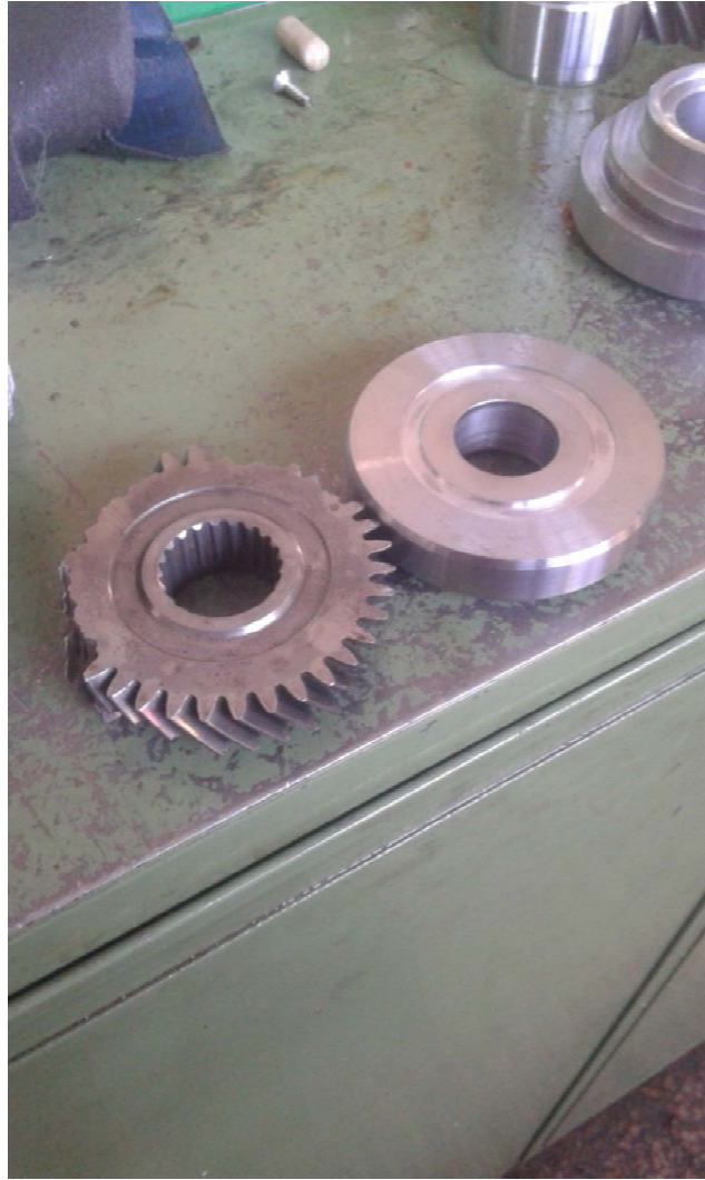
Εικόνα 25. Τελικό αποτέλεσμα του δεύτερου νέου οδοντωτού τροχού της 5ης σχέσης του κιβωτίου μετά από τη μορφοποίηση του στον CNC τόρνο.
