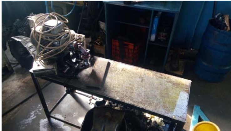
Εικόνα 55:Ειδικό χειροποίητο δοκιμαστήριο για κιβώτια ταχυτήτων.
