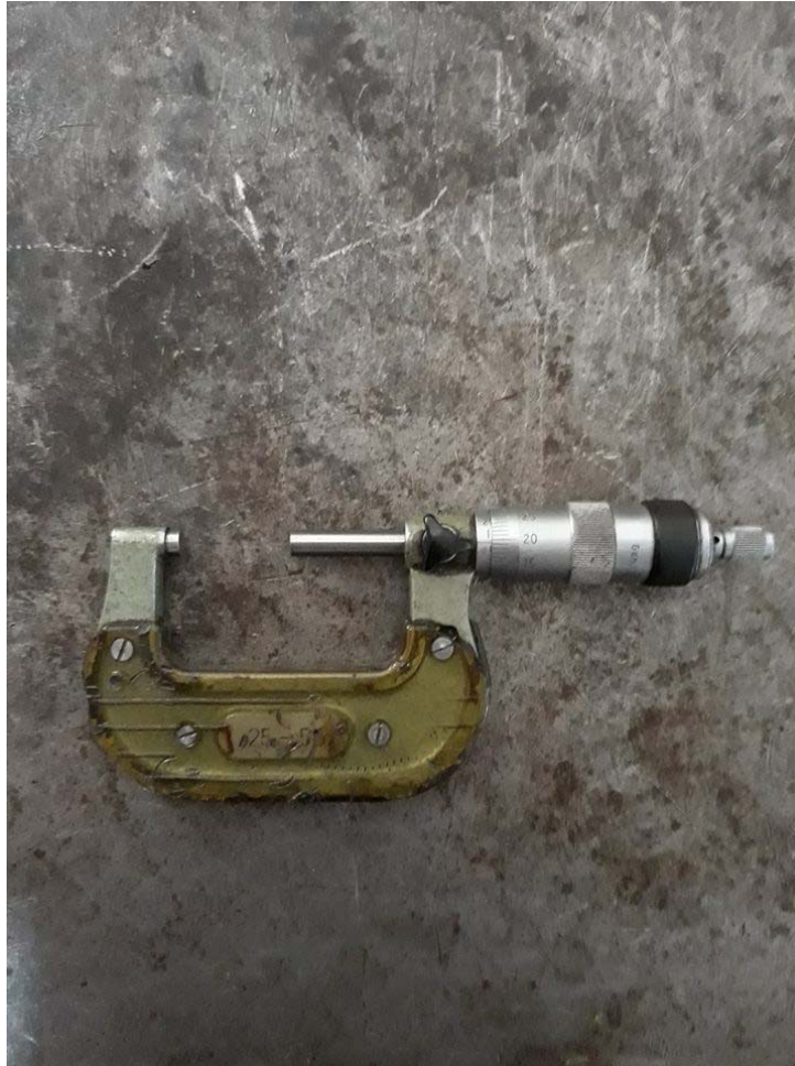
Εικόνα 9: Μικρόμετρο εξωτερικής διαμέτρου.
