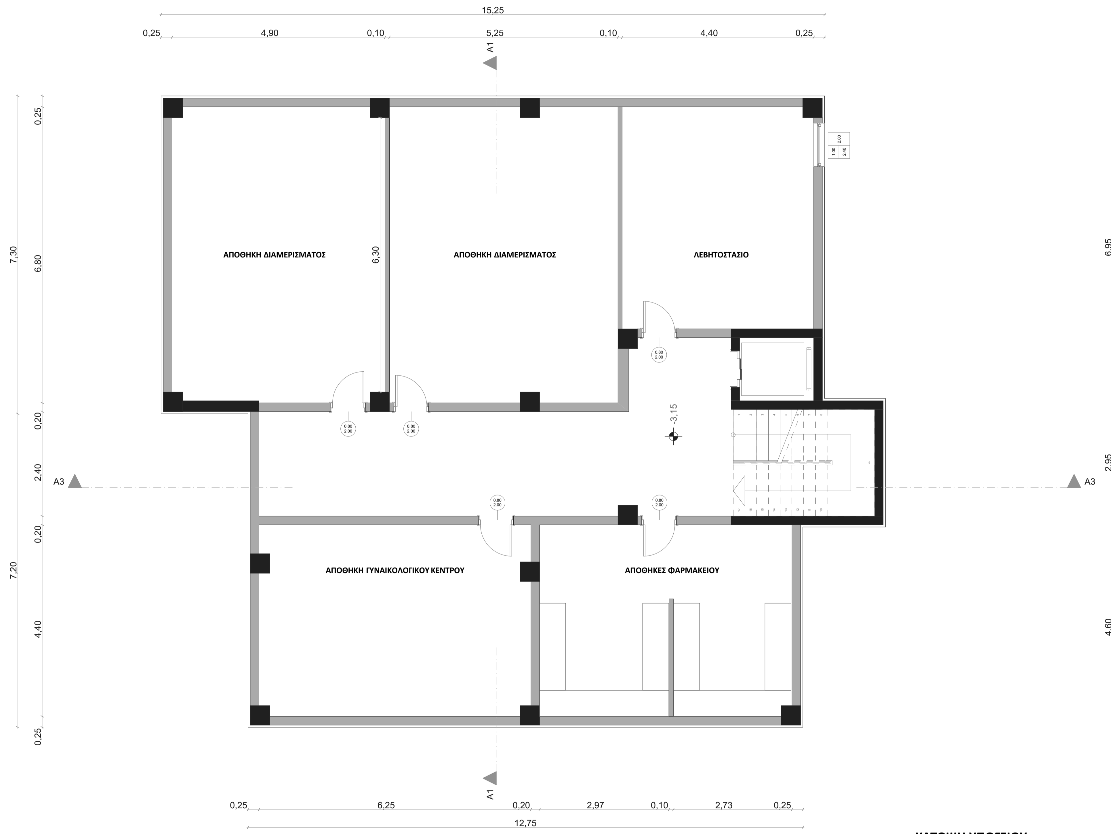
ΚΑΤΩΦΗ ΥΠΟΓΕΙΟΥ ΚΛΙΜΑΚΑ 1:50
