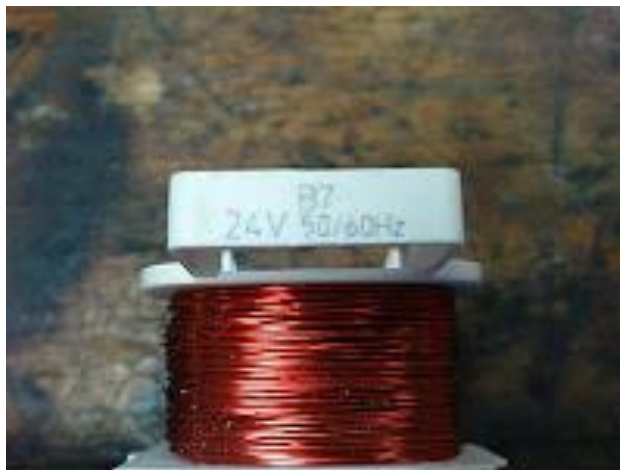
Σχήμα 33 Το πηνίο του ηλεκτρονόμου με τυπωμένη την τάση λειτουργίας του
