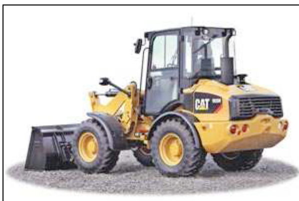
Εικόνα 3.6.3: Εκφορτωτικό μηχάνημα για τη μεταφορά της πρώτης ύλης
