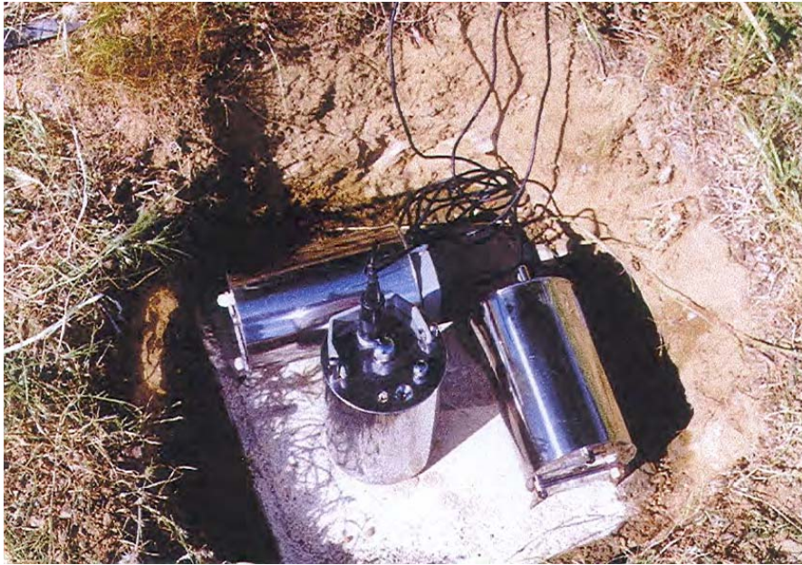
Σχ. 12 Τρία σεισμόμετρα τοποθετημένα, ένα για κάθε συνιστώσα σε σταθμό υπαίθρου.
