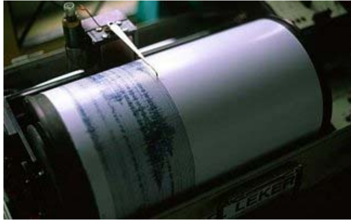
Σχ. 13 Σεισμογράφος σύγχρονου σεισμολογικού ινστιτούτου.
