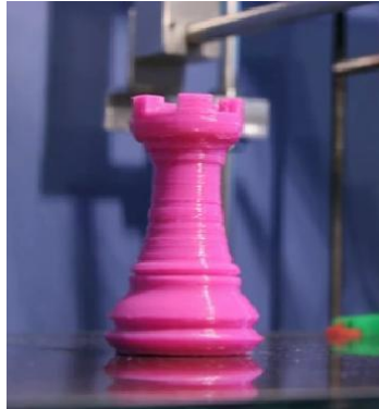
Εικόνα 1.5.2 (Κατασκευή με το RPi 3D εκτυπωτή)
