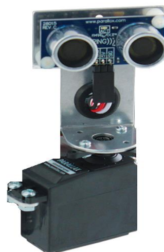
Εικόνα 2.4: Αισθητήρας Υπερήχων τοποθετημένος σε servomotor
