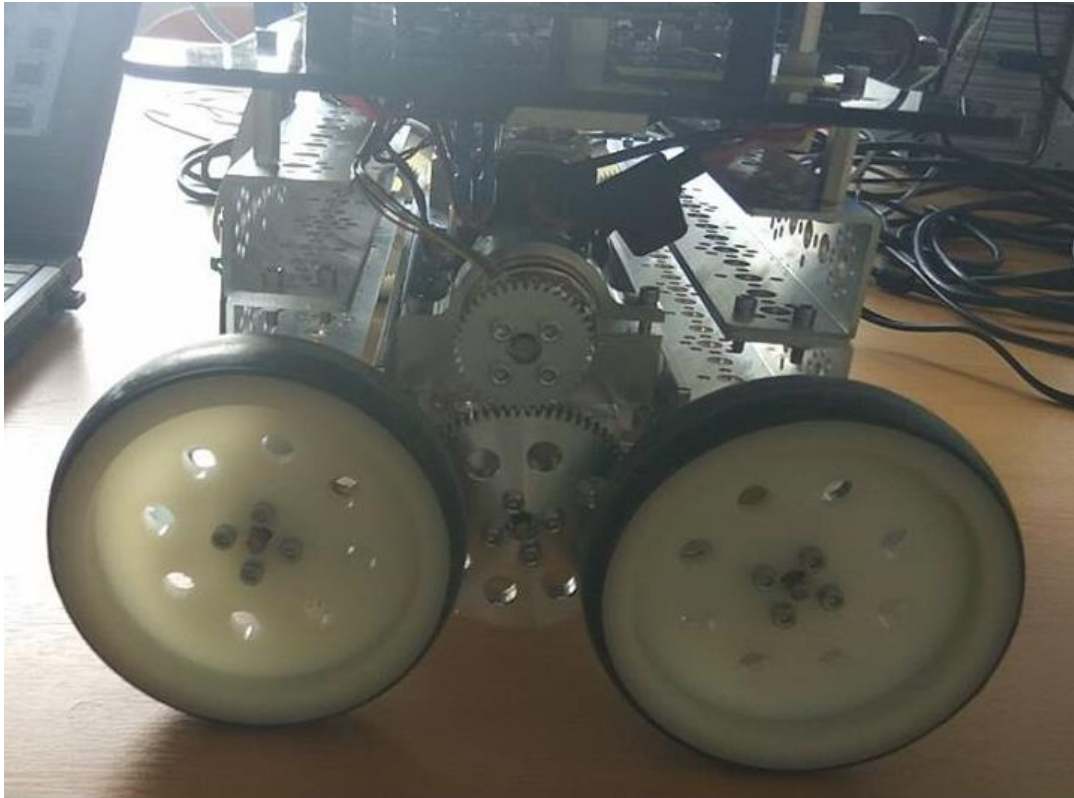
Εικόνα 5.3: Παρουσίαση του συστήματος μετάδοσης της κίνησης από τα μοτέρ στους τροχούς του οχήματος
