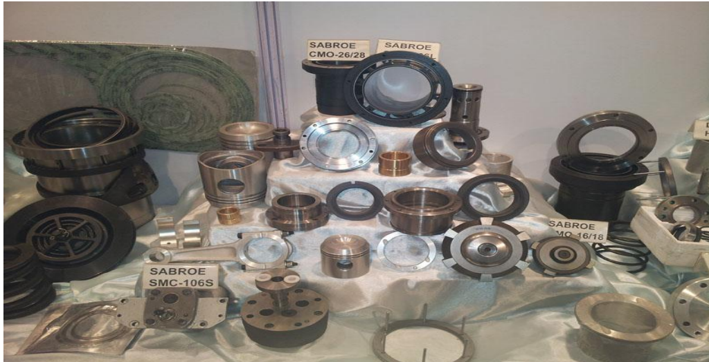
Εικόνα 6: Διάφορα εξαρτήματα παλινδρομικού συμπιεστή
