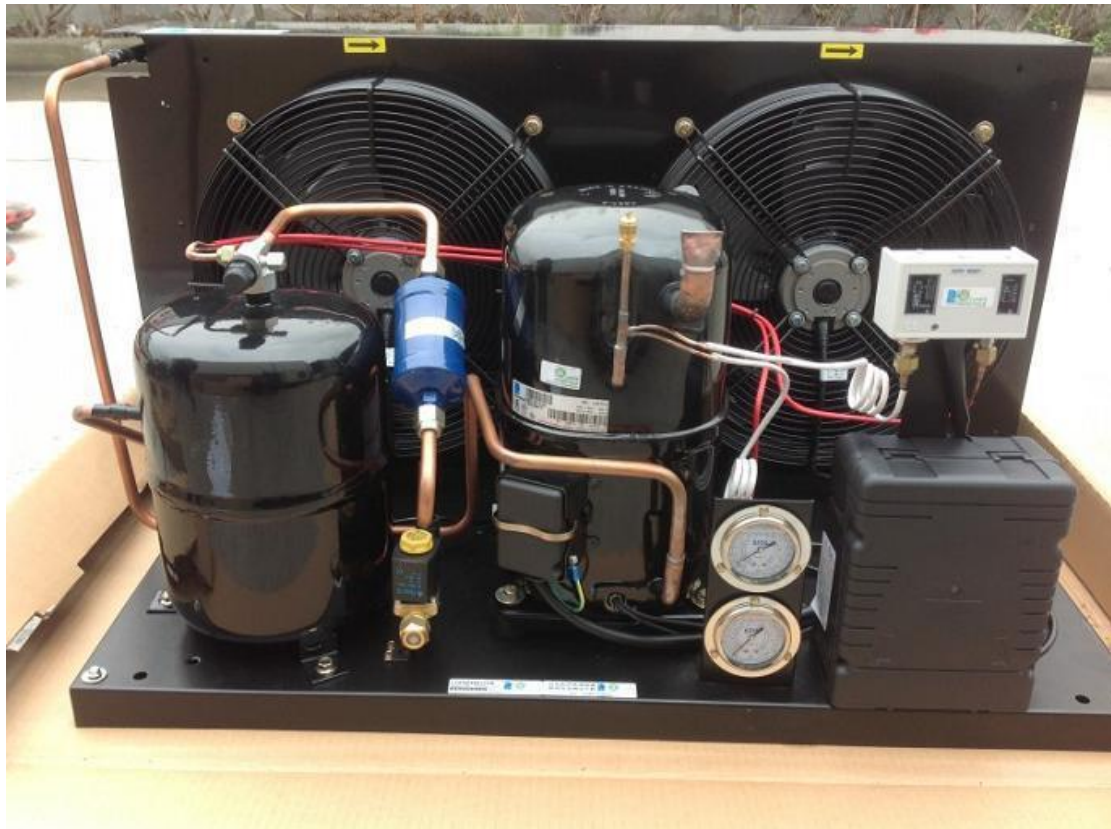
Εικόνα 36: Μονάδα συμπίκνωσης με αερόψυκτο συμπυκνωτή εξαναγκασμένης κυκλοφορίας
