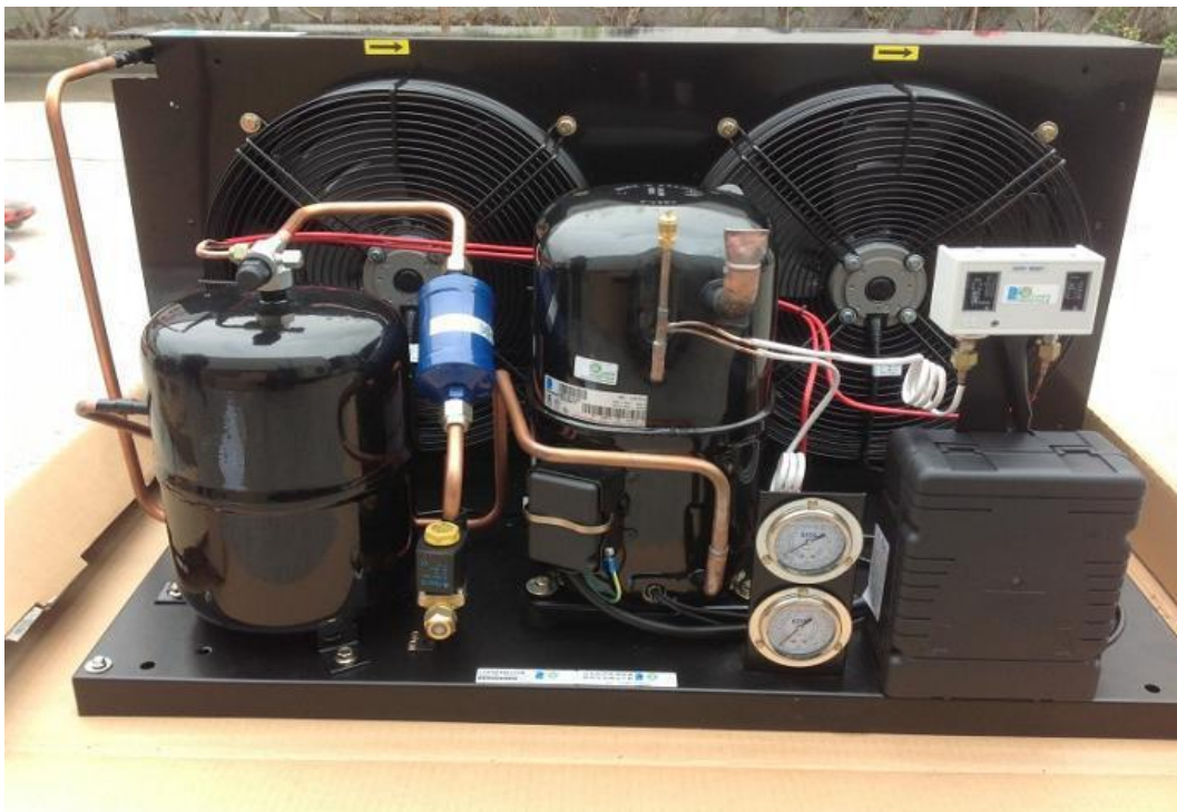
Εικόνα 13: Μονάδα συμπύκνωσης λειτουργίας με ερμητικά κλειστό συμπιεστή
