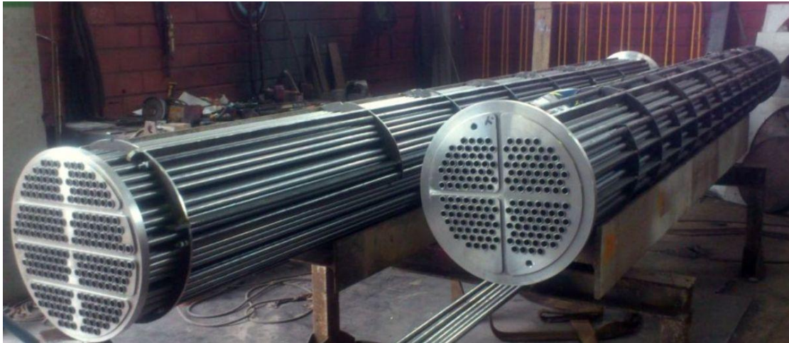
Εικόνα 33: Αυλοί υδρόψυκτου συμπυκνωτή κελύφους αυλών στο στάδιο της κατασκευής
