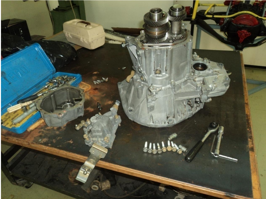
8. Βγάλθηκε ότι υπήρχε τριγύρω όπως επίσης αποσυναρμολογήθηκαν οι βίδες του κεντρικού κορμού.
