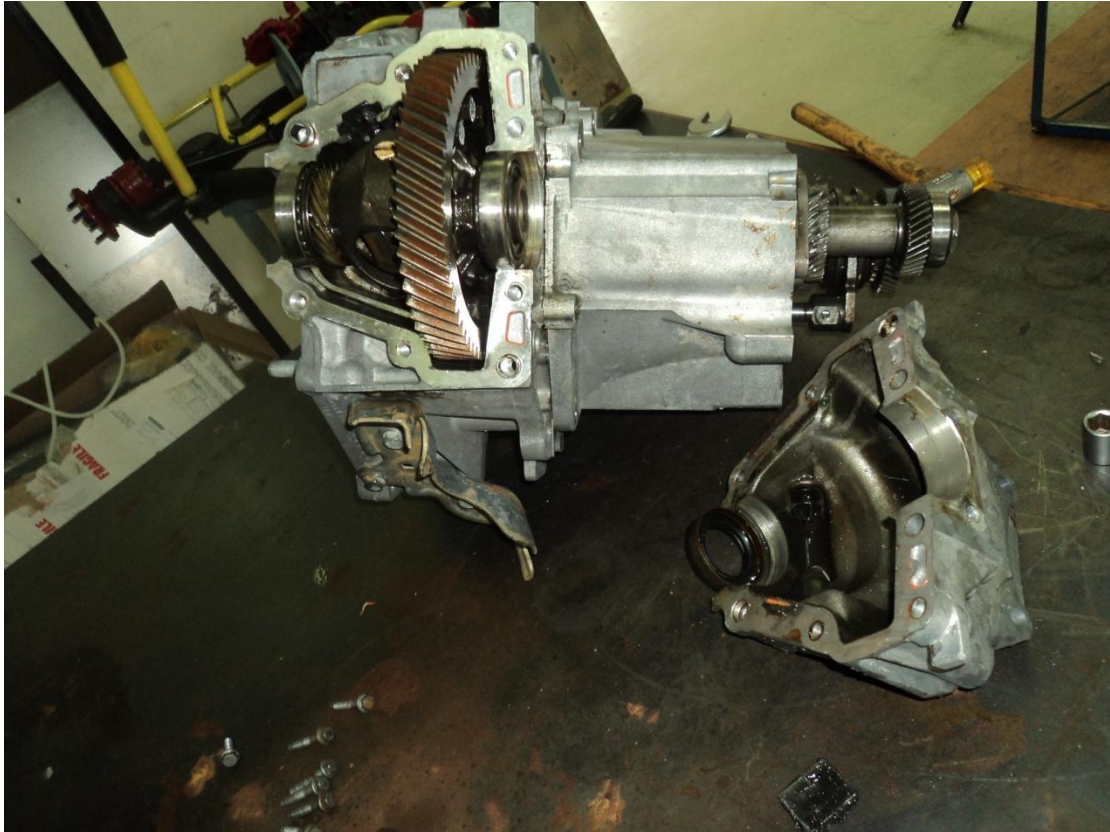
9. Αποσυναρμολογήθηκε το καπάκι του διαφορικού έτσι ώστε να εξετασθεί και αυτό.
