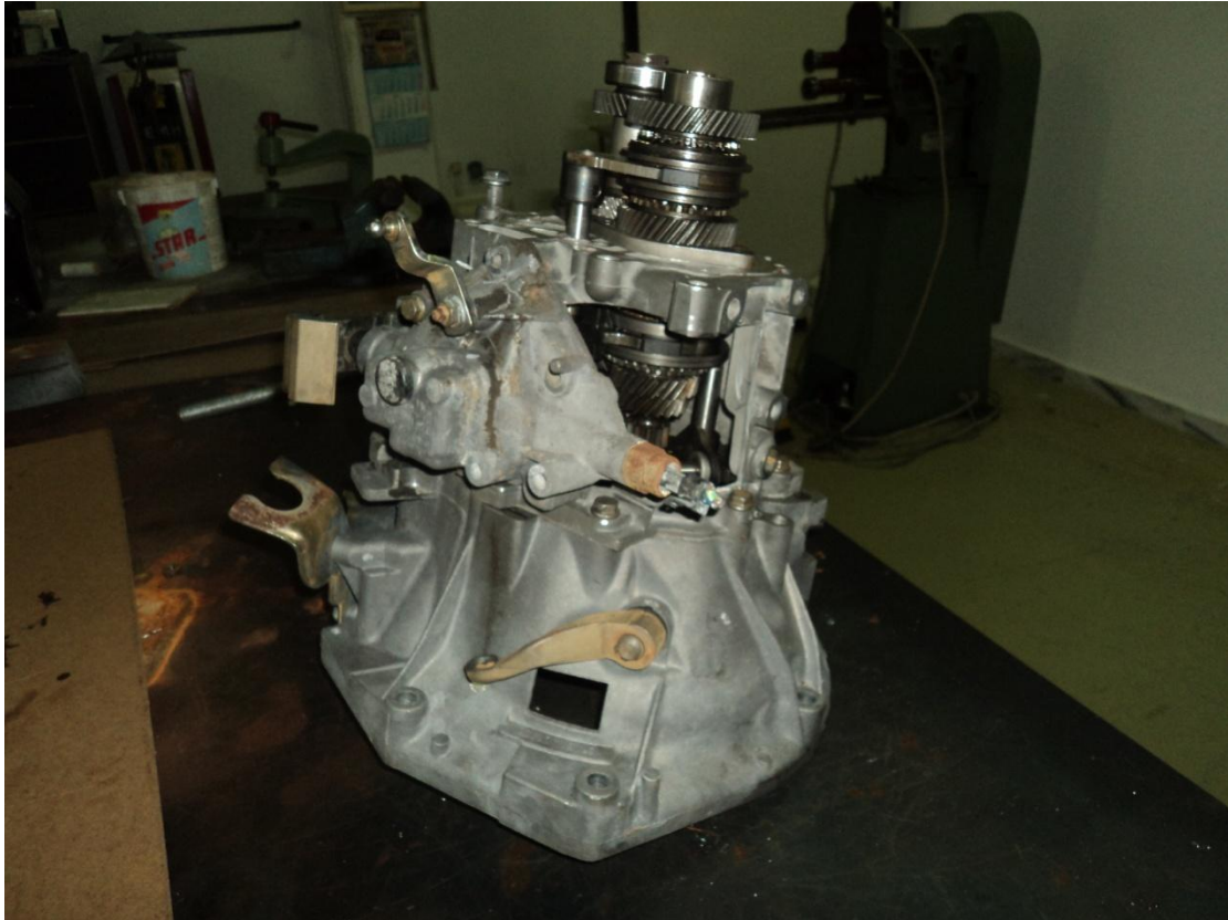
28. Το κιβώτιο ταχυτήτων συναρμολογημένο και στην τελική του μορφή. (πάνω-κάτω φωτογραφία)
