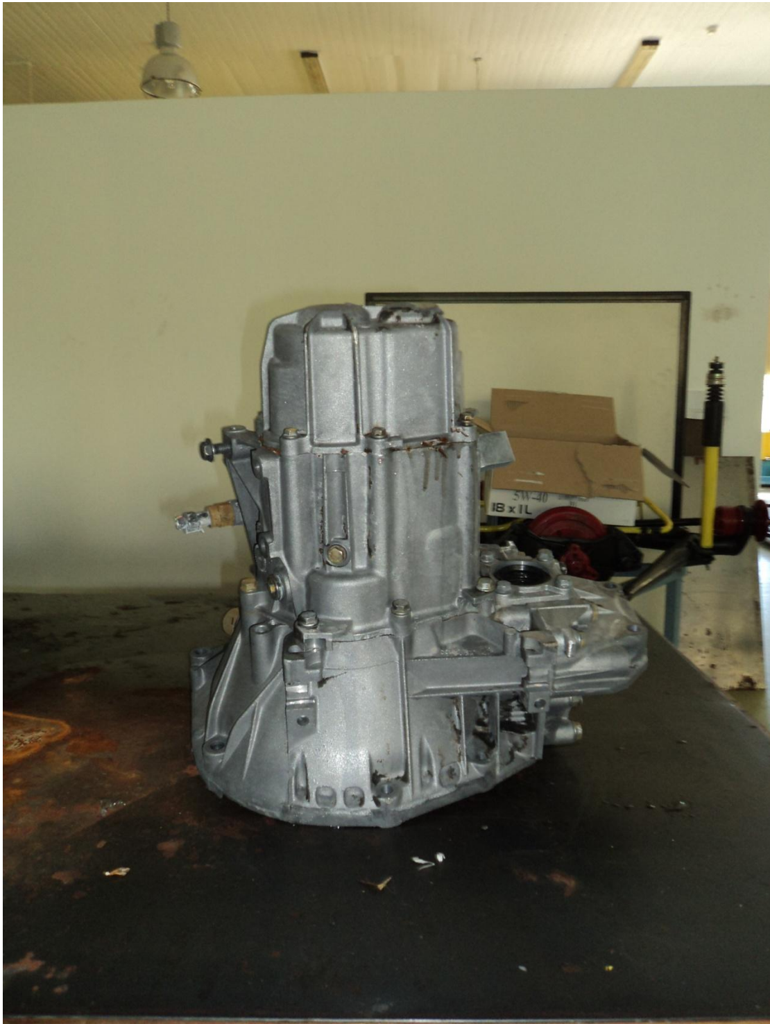
4. Στο πάνω μέρος βρίσκεται το καπάκι που περιέχει την 5 η και 6 η ταχύτητα και ακριβώς από κάτω ο κύριος κορμός που περιέχει τις υπόλοιπες ταχύτητες.
