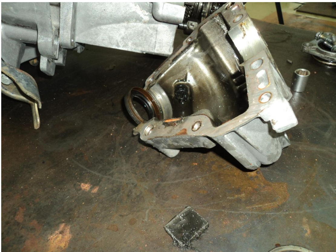
10. Στο κάτω μέρος της εικόνας παρατηρείτε ένα σπασμένο κομμάτι το οποίο είναι οδηγός για να τοποθετηθεί με ευκολία και ακρίβεια το καπάκι του διαφορικού.
