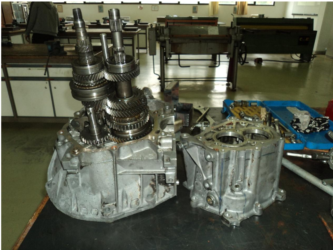
26. Επανατοποθέτηση του κιβωτίου ταχυτήτων πάνω στην χελώνα.
