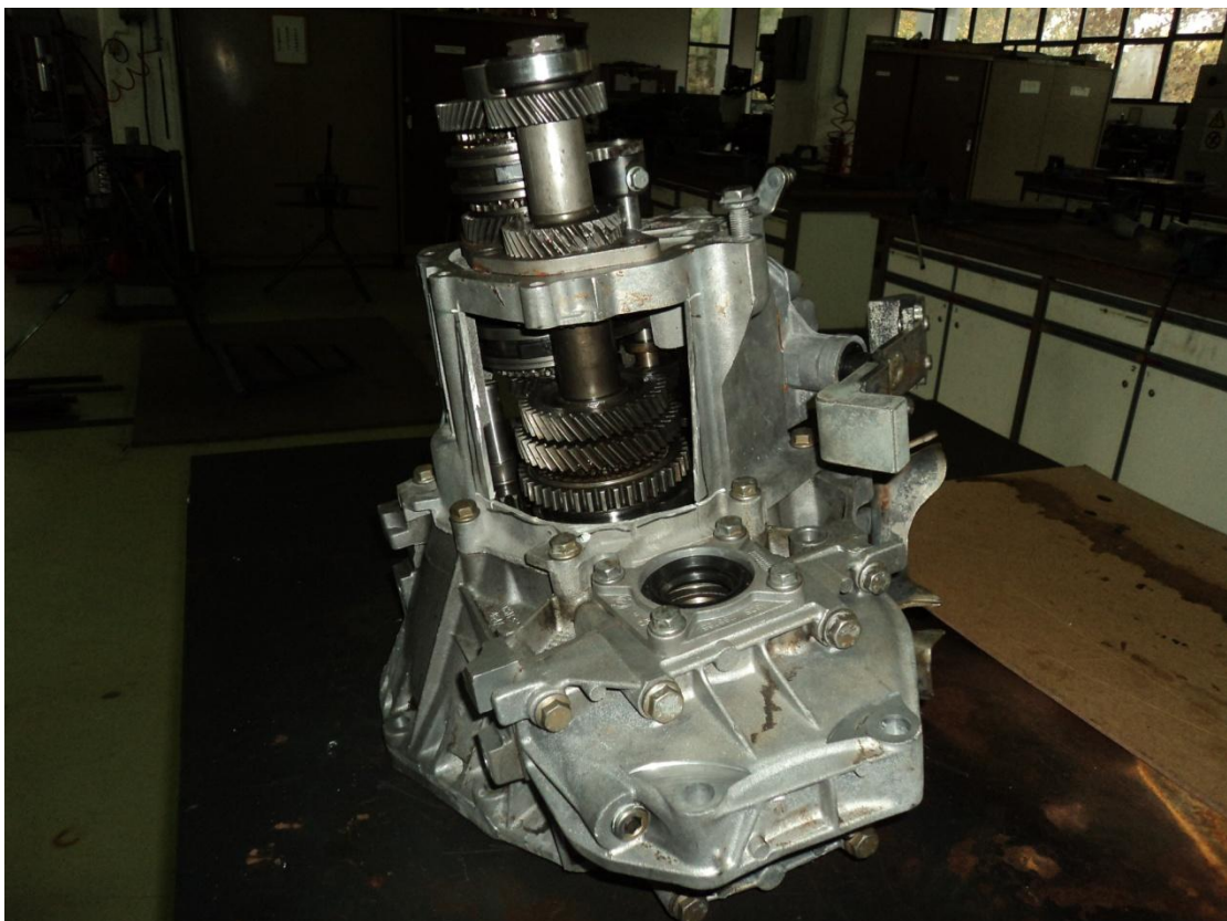
28. Το κιβώτιο ταχυτήτων συναρμολογημένο και στην τελική του μορφή. (πάνω-κάτω φωτογραφία)
