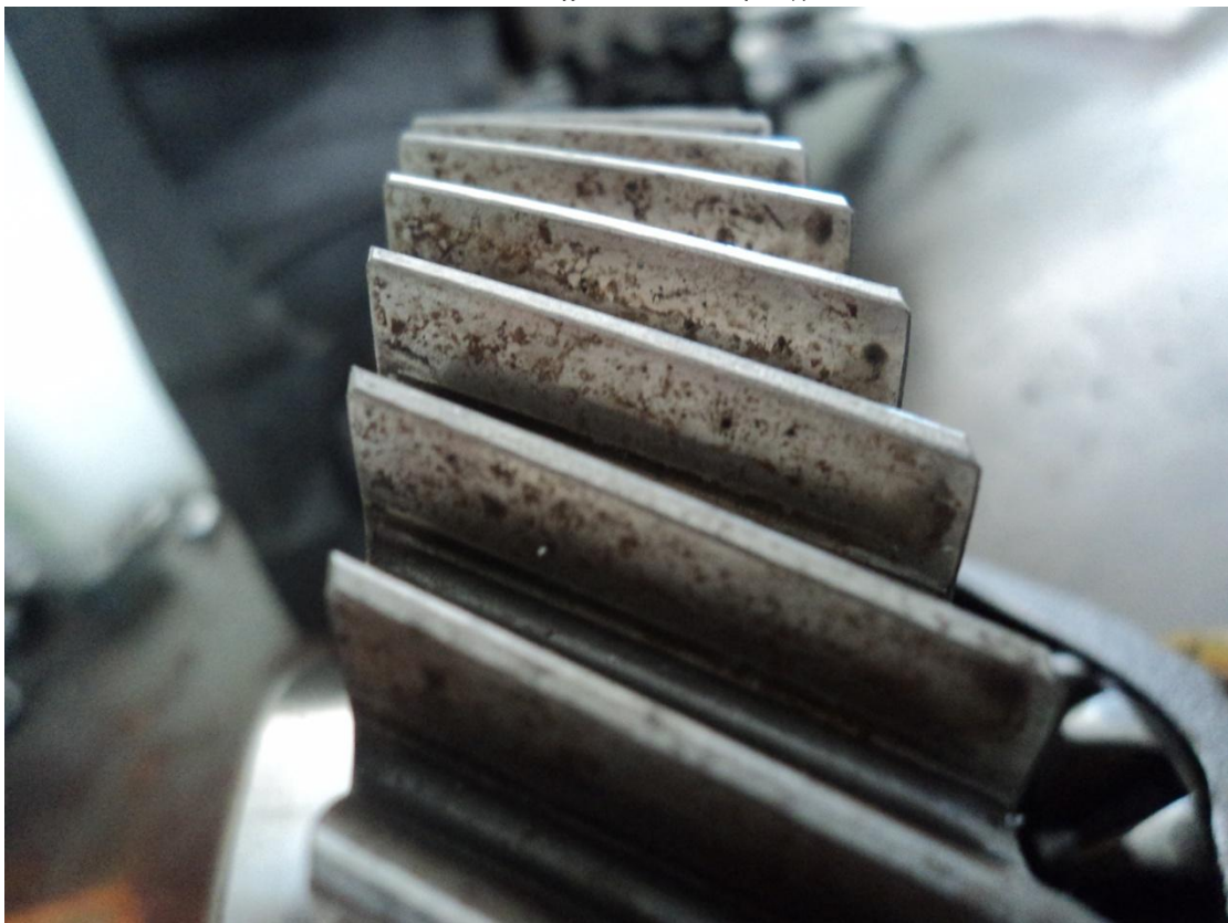
13. Εκκοιλάνσεις. Κόπωση υλικού στην ενεργεία παρειά και αποκόλληση τεμαχιδίων υλικού
