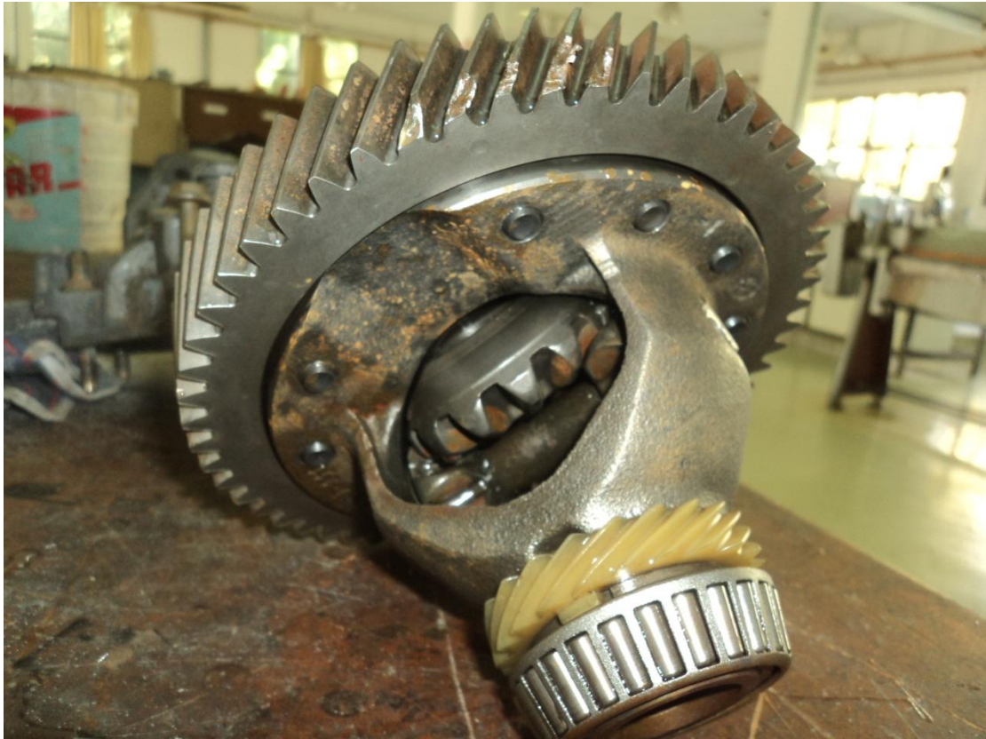
11. Το γρανάζι το οποίο παίρνει κίνηση από το κιβώτιο ταχυτήτων και την μεταδίδει στους τροχούς έχει υποστεί ζημιά σε 5 δόντια εξ αυτού. Είναι εμφανής και οι πλανήτες.
