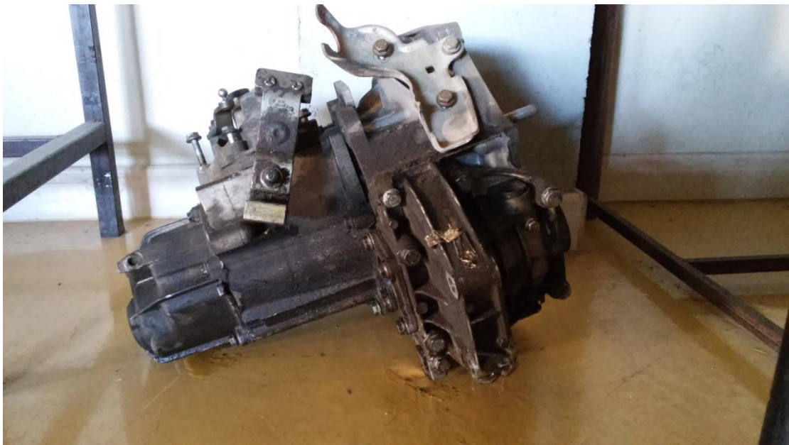
1. Το κιβώτιο ταχυτήτων μετά την αφαίρεσή του από το αυτοκίνητο.
