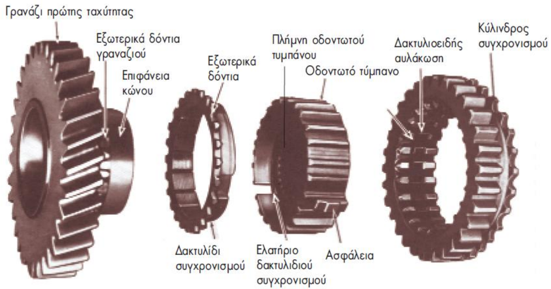
3.3 Αποσυναρμολογημένος μηχανισμός συγχρονισμού με ανεξάρτητο δακτυλίδι συγχρονισμού
