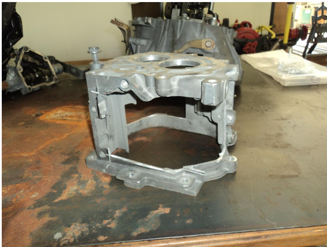
27. Το κέλυφος του κιβώτιου ταχυτήτων σε τομή. (πάνω - κάτω φωτογραφία)
