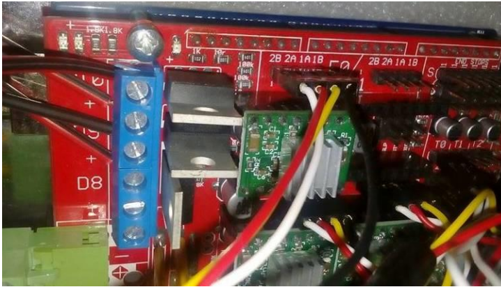
Σχήμα 3.33 : Σύνδεση βηματικών κινητήρων στην RAMPS με τα ειδικά συνδετικά.
