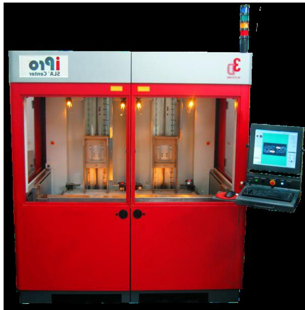
Σχήμα 2.2: 3D Systems iPro 9000 Stereolithography system από τις τελευταίες SLA μηχανές της 3D Systems Inc.
