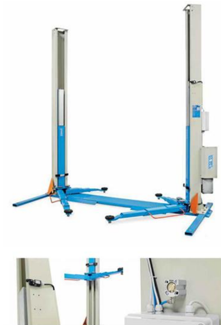
Σχήμα 3.16: Δικόλωνος ηλεκτροϋδραυλικός ανυψωτήρας 3,2t (2,2 kW). (ART.199/UE – OMCN).
