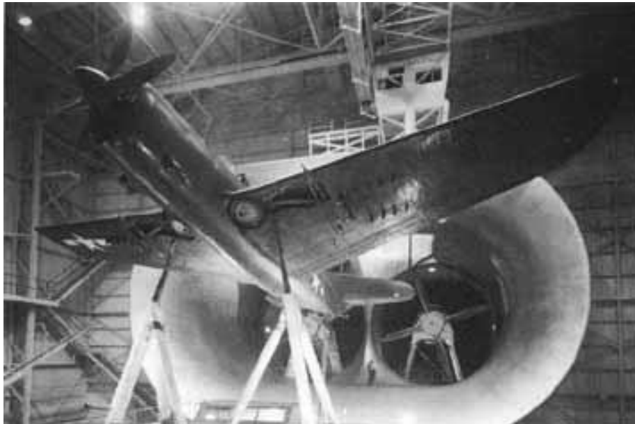
fig. 20 Το βομβαρδιστικό αεροσκάφος Curtiss SB2C-4 Helldiver τοποθετείται στην αεροσήραγγα του Langley, Virginia για διερεύνηση της οπισθέλκουσας δύναμης.
