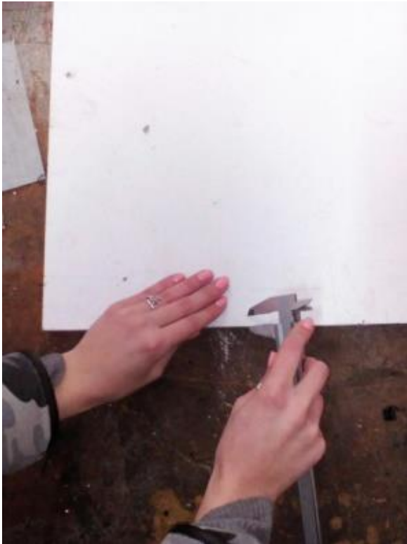
fig. 68 Σημάδεμα MDF στα 8mm για τα κέντρα των οπών.
