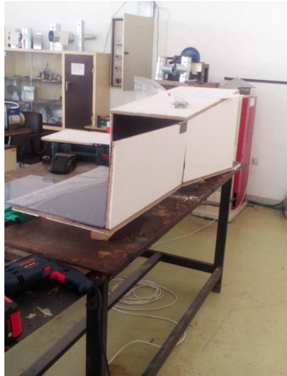
fig. 67 Ένωση των δύο θαλάμων και πρόχειρη στήριξη της αεροσήραγγας πάνω σε τάκους.
