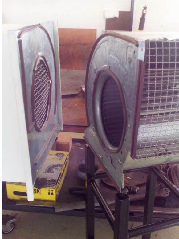
fig. 95 Τοποθέτηση ανεμιστήρα στην βάση του. Στην φωτογραφία φαίνονται οι προστατευτικές σίτες, τα στεγανοποιητικά αυτοκόλλητα στα σημεία επαφής και οι ρυθμιστικές βίδες του ύψους.
