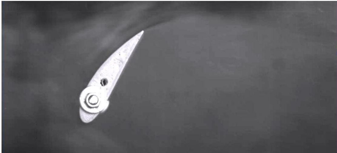
fig. 109 Εικόνα από την βιντεοσκόπηση του πειράματος όπου διαφαίνεται ο σχηματισμός οριακού στρώματος (boundary layer) στην επιφάνεια αναρρόφησης του πτερυγίου θέσης 55^\circ .
