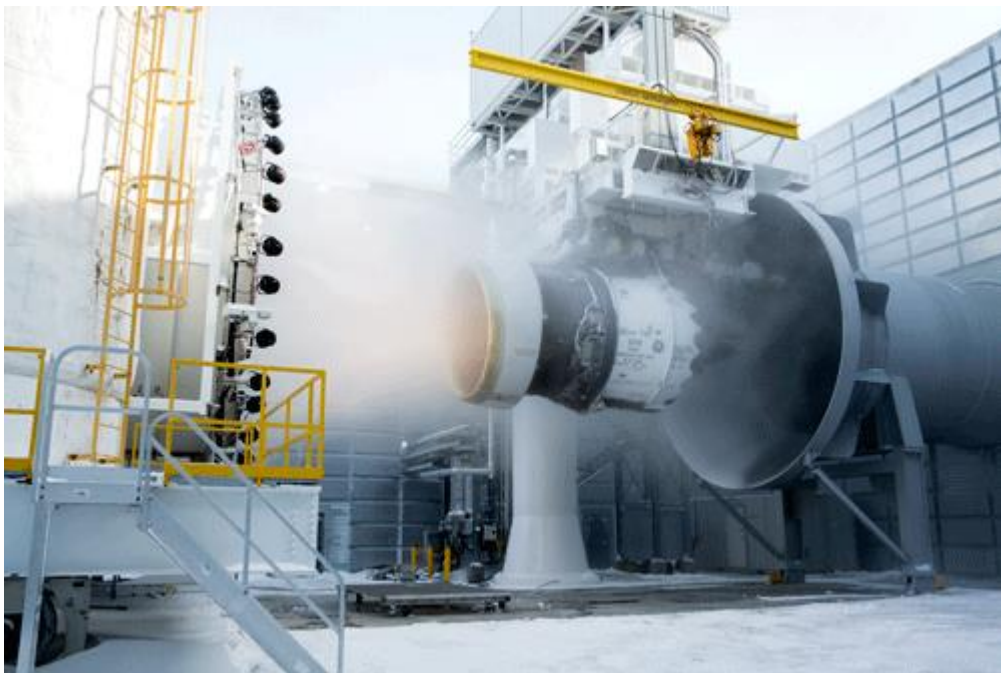
fig. 25 Ο κινητήρας του επιβατικού αεροσκάφους GENX κατά την διάρκεια της δοκιμής του στην αεροσήραγγα του Καναδά.
