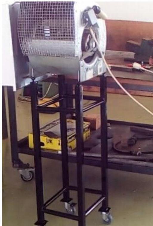
fig. 96 Ο ανεμιστήρας τοποθετημένος στην βάση με τις τέσσερις ρόδες εκ των οποίων οι δύο χιαστί διαθέτουν φρένο ασφαλείας.
