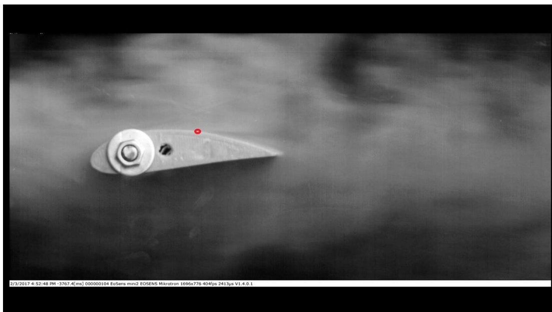
fig. 111 Πτερύγιο στην θέση 0°. Στο κόκκινο σημείο φαίνεται το σημείο αποκόλλησης.
