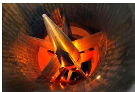
fig. 32 Ο ανεμιστήρας της αεροσήραγγας της General Motors στο Michigan με διάμετρο 13 μέτρα, ταχύτητα ανέμου 200km/h και ισχύ 3335KW που τροφοδοτείται με συνεχές ρεύμα.
