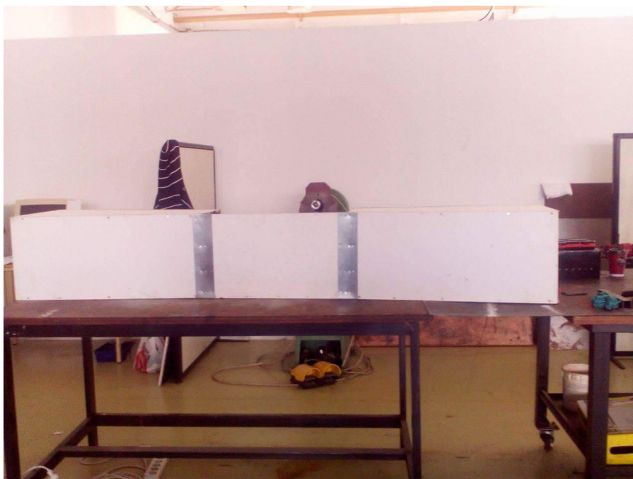
fig. 70 Όψη της αεροσήραγγας που φαίνονται τα σημεία μετωπικής σύνδεσης με λαμαρίνα και ξυλόβιδες.
