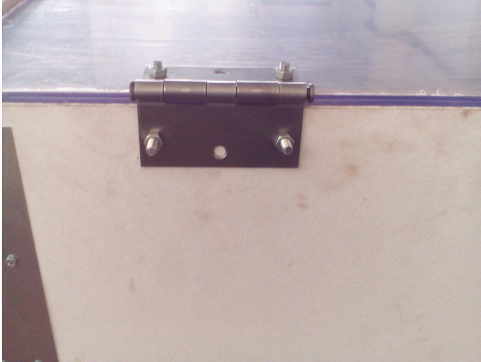
fig. 73 Τοποθέτηση plexiglass με μεντεσέ (Εξωτερική όψη).
