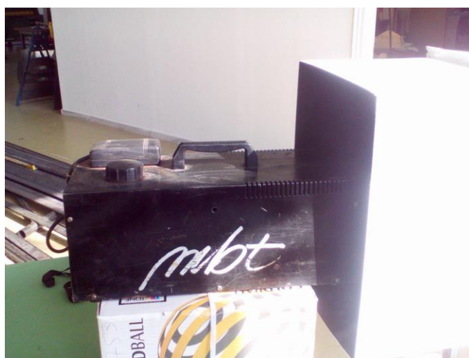
fig. 105 μηχανήμα καπνού MBT Lighting FM5000Z_86676 αναρτημένο στην εισαγωγή της αεροσήραγγας.
