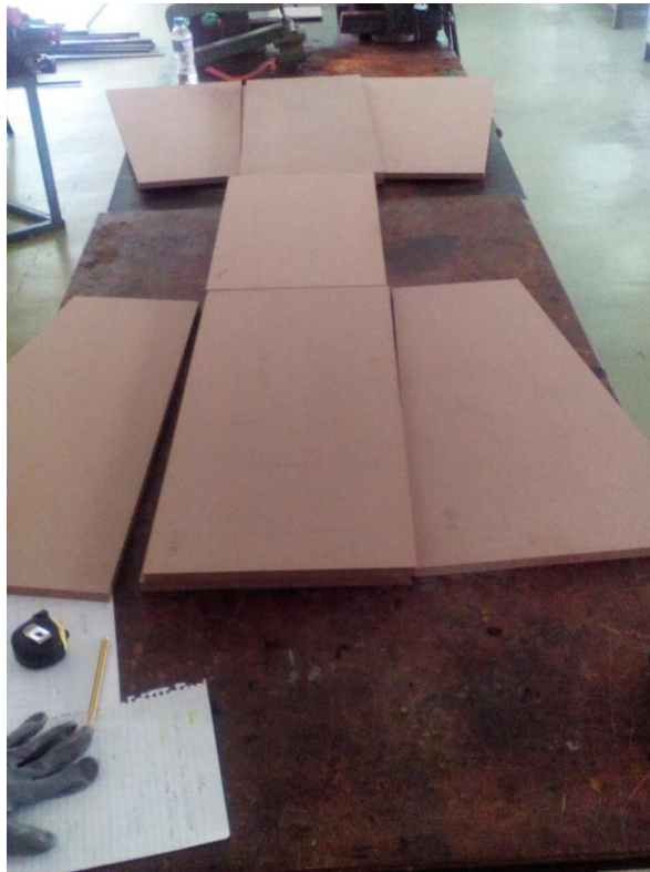
fig. 64 Οι πλάκες από ινοσανίδο MDF πάχους 16mm όπως τις παραλάβαμε από το ξυλουργείο.
