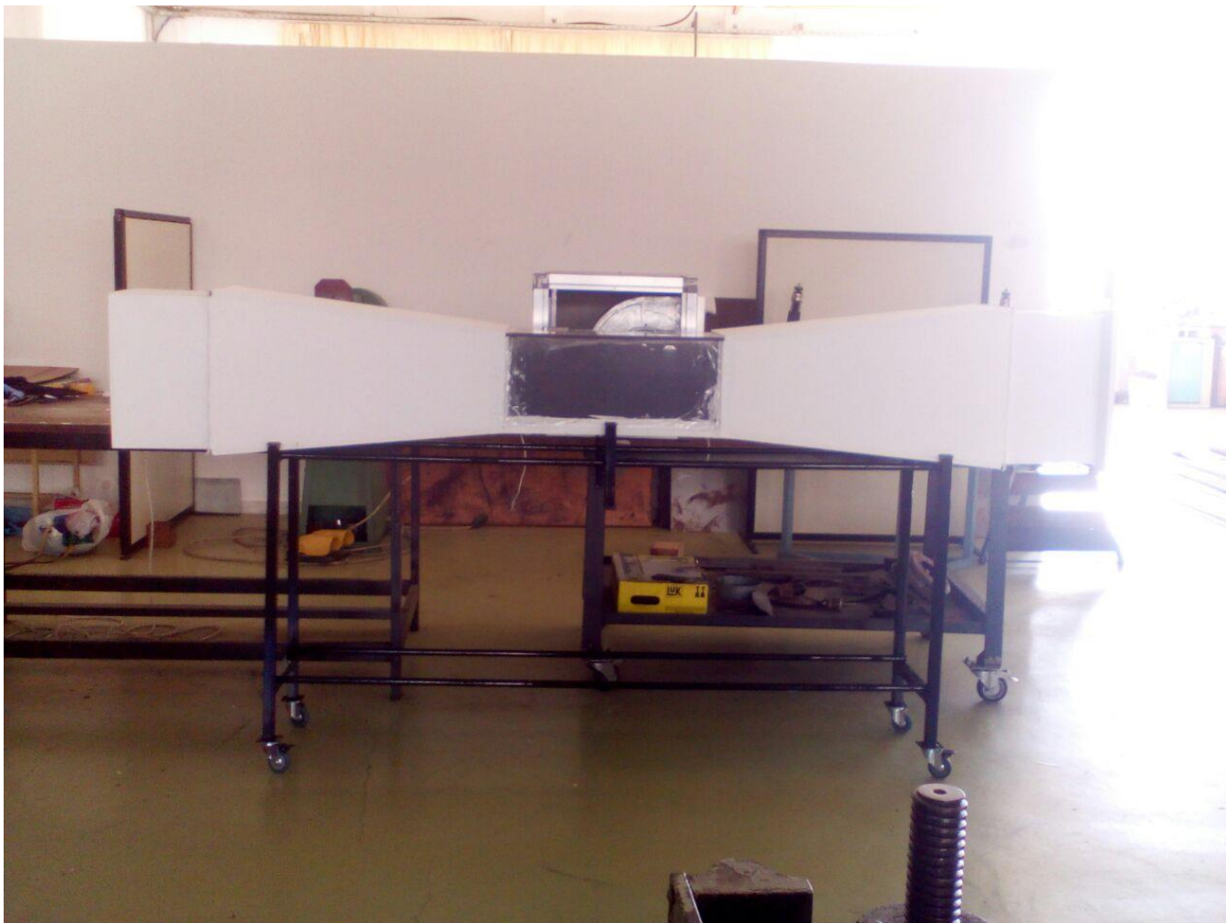
fig. 86 Η αεροσήραγγα πάνω στην βάση της.
