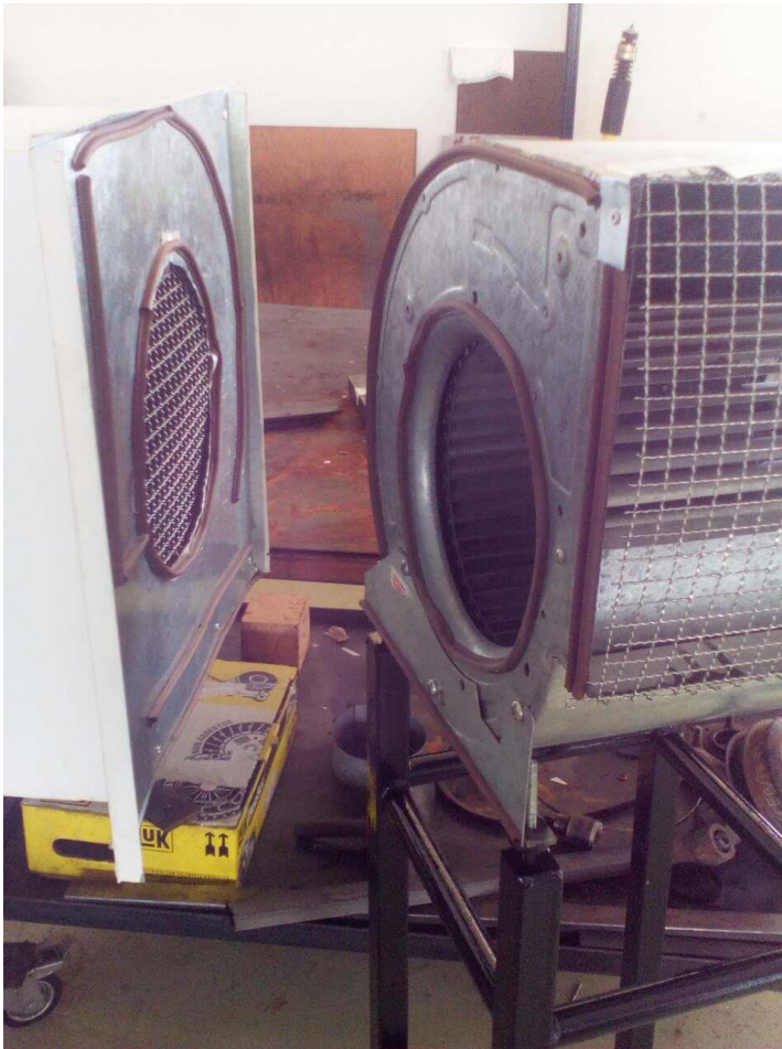
fig. 95 Τοποθέτηση ανεμιστήρα στην βάση του. Στην φωτογραφία φαίνονται οι προστατευτικές σίτες, τα στεγανοποιητικά αυτοκόλλητα στα σημεία επαφής και οι ρυθμιστικές βίδες του ύψους.
