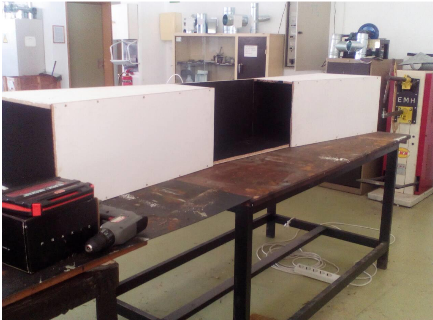
fig. 69 Ένωση των τριών θαλάμων. Στην συνέχεια τοποθετήθηκαν περισσότερες ξυλόβιδες για μεγαλύτερη στιβαρότητα και ασφάλεια.
