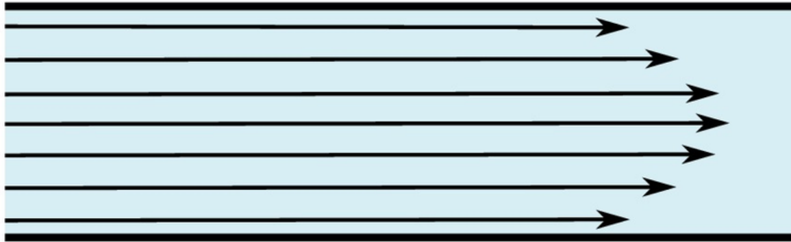
fig. 3 Στρωτή ροή μέσα σε αγωγό.
