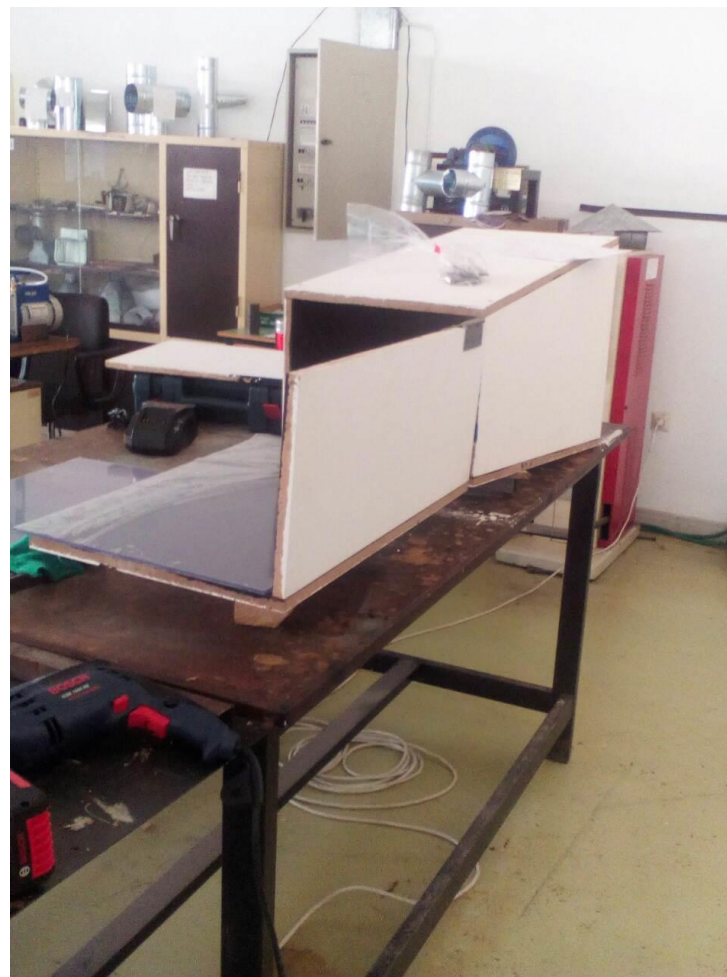
fig. 67 Ένωση των δύο θαλάμων και πρόχειρη στήριξη της αεροσήραγγας πάνω σε τάκους.
