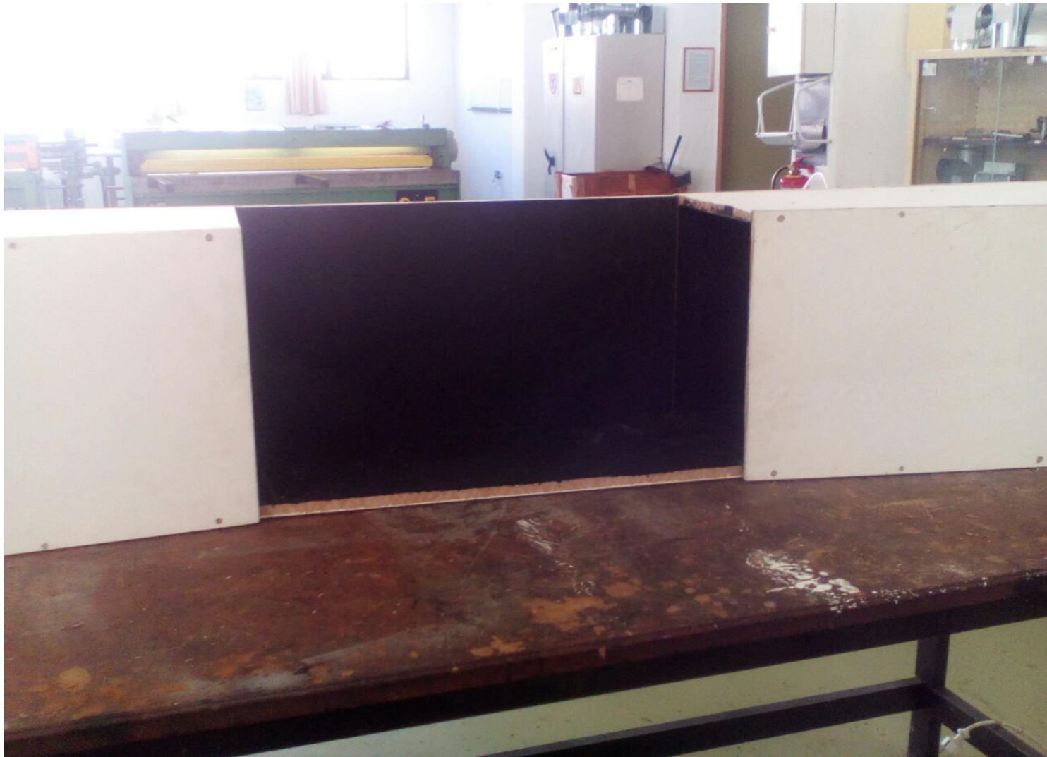
fig. 71 Όψη του θαλάμου δοκιμών που αποτελείται από δύο ινοσάνιδα και δύο plexiglass που θα τοποθετηθούν αργότερα.
