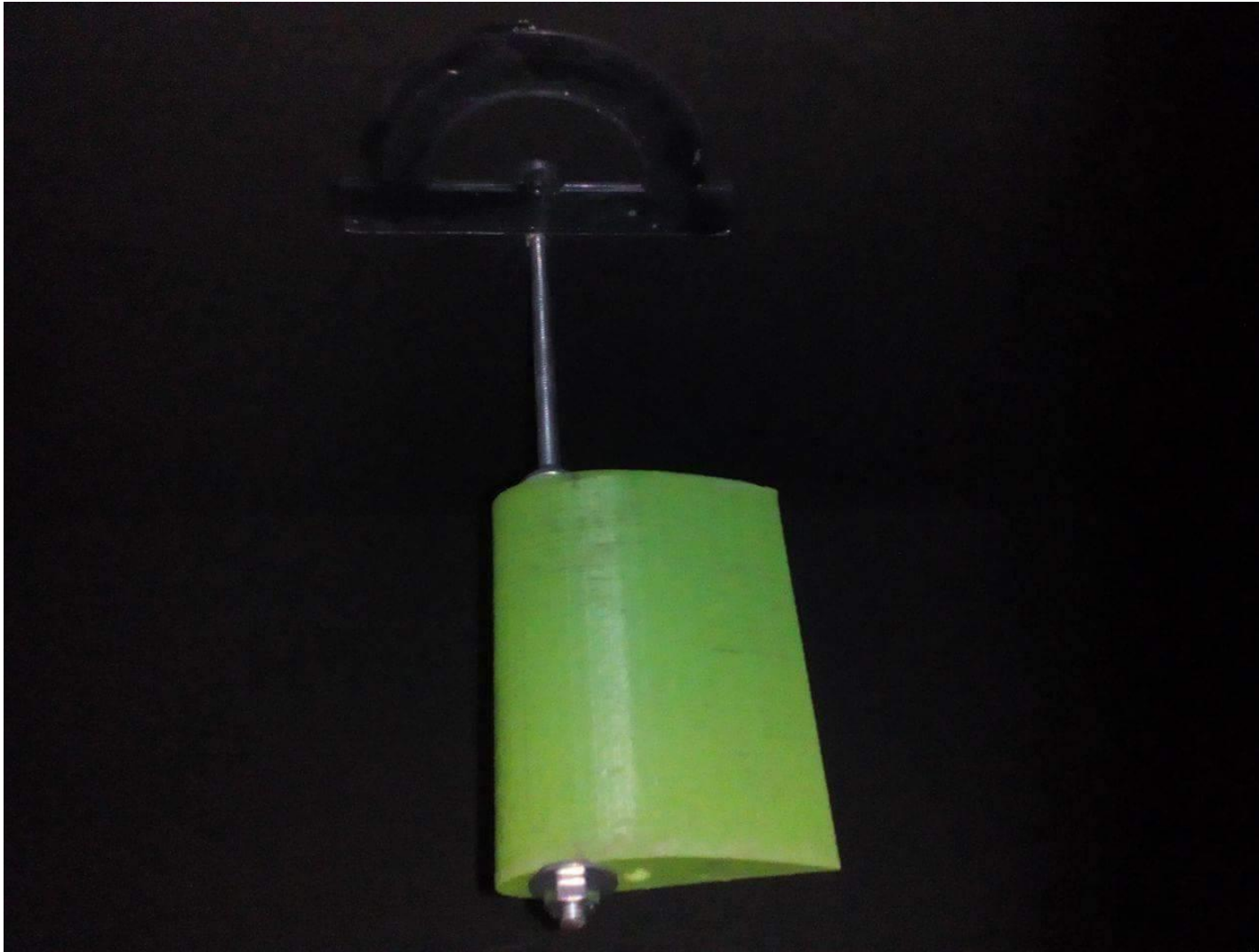
fig. 106 Το πτερύγιο NACA 5522 αναρτημένο στον θάλαμο δοκιμών της αεροσήραγγας.
