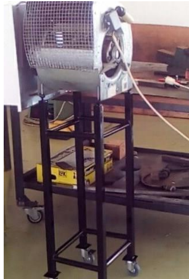
fig. 95 Τοποθέτηση ανεμιστήρα στην βάση του. Στην φωτογραφία φαίνονται οι προστατευτικές σίτες, τα στεγανοποιητικά αυτοκόλλητα στα σημεία επαφής και οι ρυθμιστικές βίδες του ύψους.
