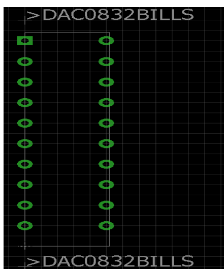
Σχήμα 0-11 Το Package για το DAC0832 στο Eagle 7.6.0.
