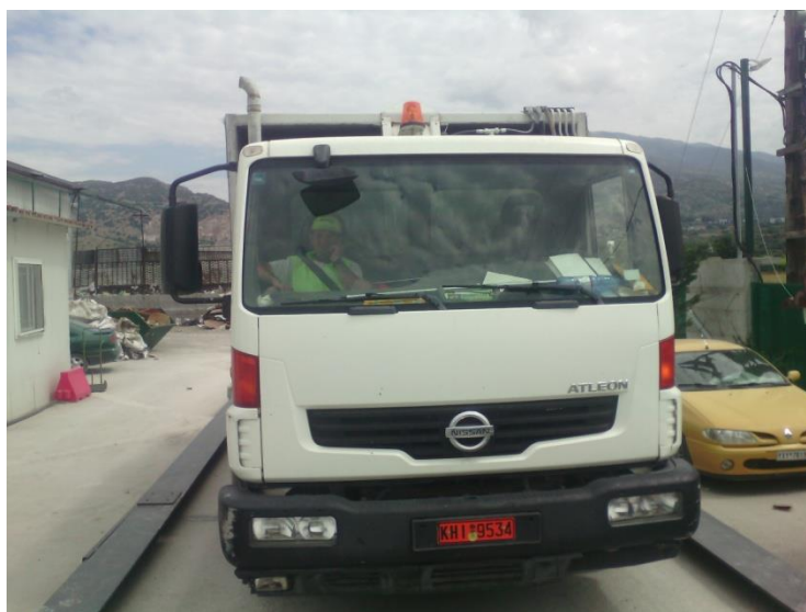
Εικόνα 2: Ζύγισμα απορριμματοφόρου σε γεφυροπλάστιγγα
