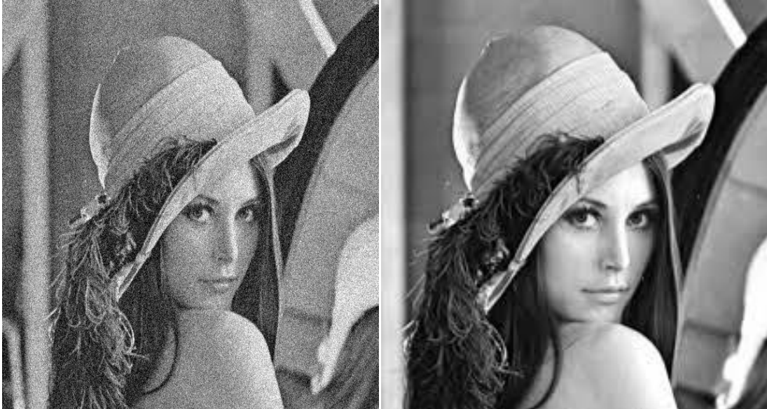
Σχήμα 7: Αριστερά εικόνα με θόρυβο και δεξιά μετά την εφαρμογή της Medfilt2
