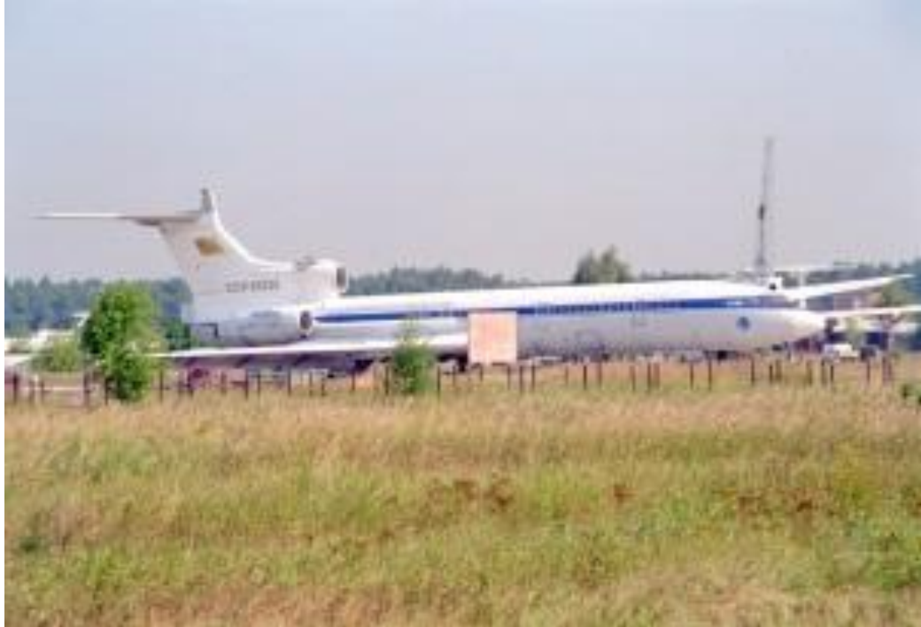
Εικόνα 19-2 Το Tupolev Tu-155 είναι ένα τροποποιημένο Tu-154 (СССР-85035), το οποίο είχε χρησιμοποιηθεί ως εναλλακτική λύση πλατφόρμα δοκιμών καυσίμων. Αυτό είναι το πρώτο πειραματικό αεροσκάφος στον κόσμο που λειτουργεί με υγρό υδρογόνο!
