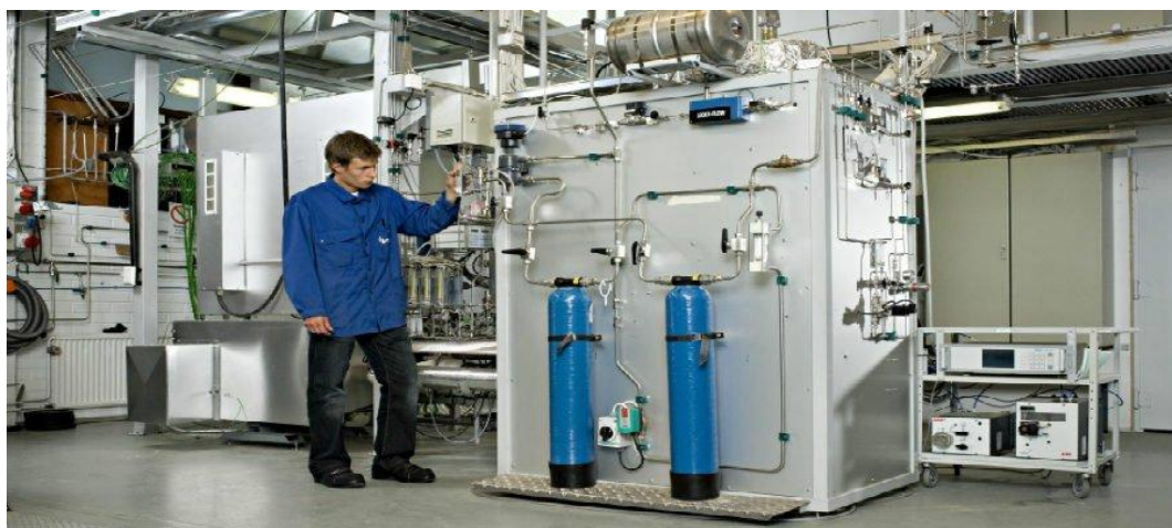
Εικόνα 6-6 μονάδα επίδειξης 5kWκυψέλης καυσίμου στερεού οξειδίου. Η μονάδα λειτουργήσει για 7000 ώρες με 5 kW(SOFC)
