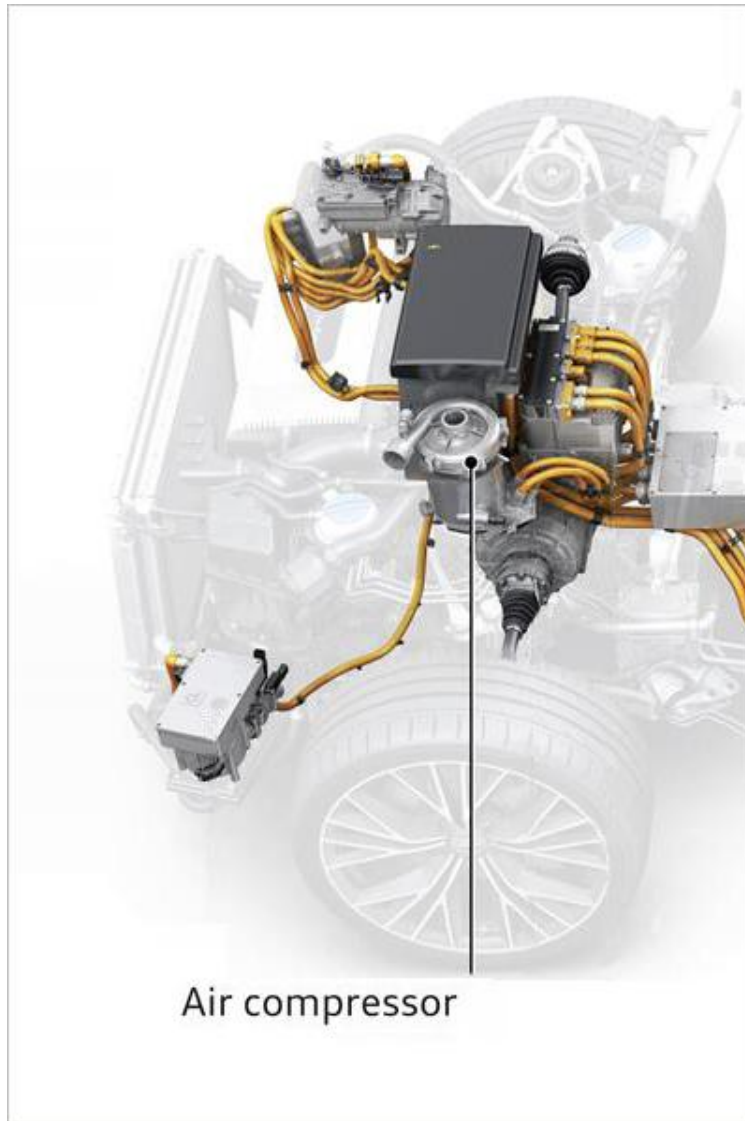
Εικόνα 7-8 Η θέση του αεροσυμπιεστή σε ένα αυτοκίνητο με κυψέλη καυσίμου
