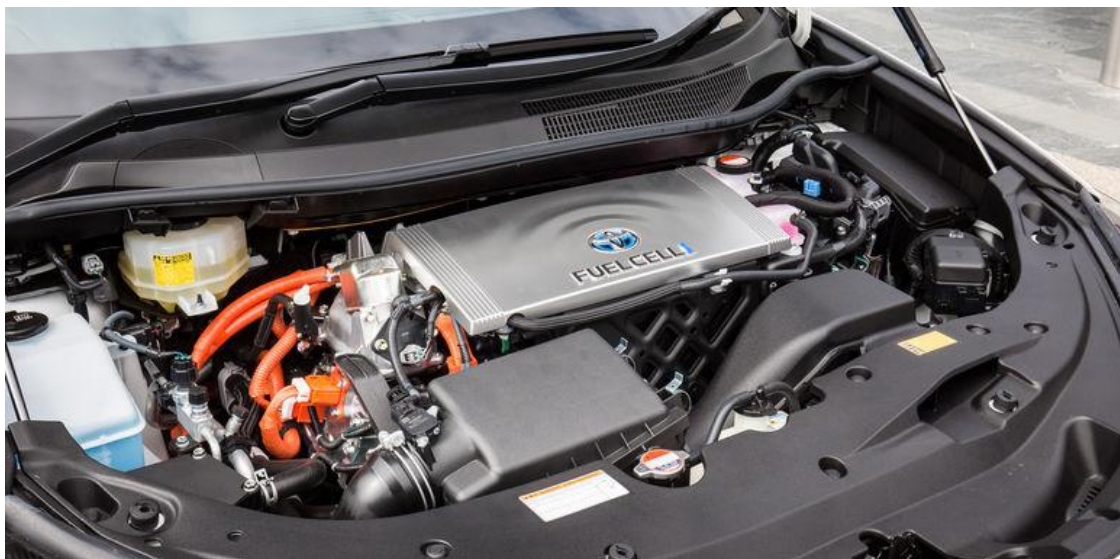
Εικόνα 21-3 Η κυψέλη καυσίμου , το μηχανικό τμήμα του Toyota mirai
