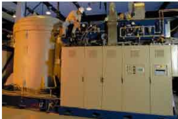
Εικόνα 6-5 Μια πιο σύγχρονη κυψέλη καυσίμου φωσφορικού οξέος
