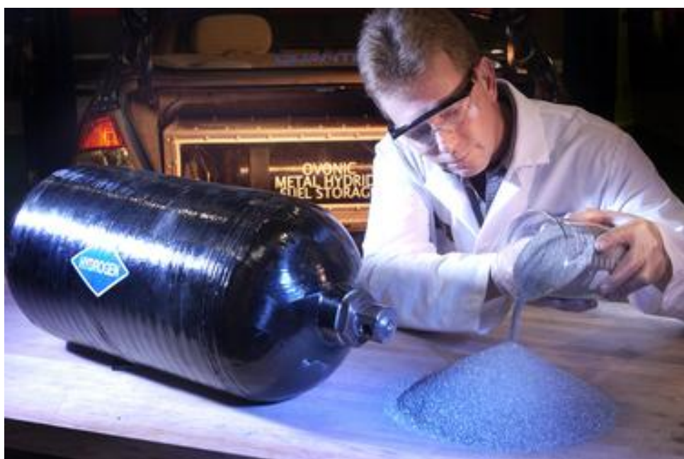
Εικόνα 10-4 Δεξαμενή αποθήκευσης για μεταλλικά υβρίδια
