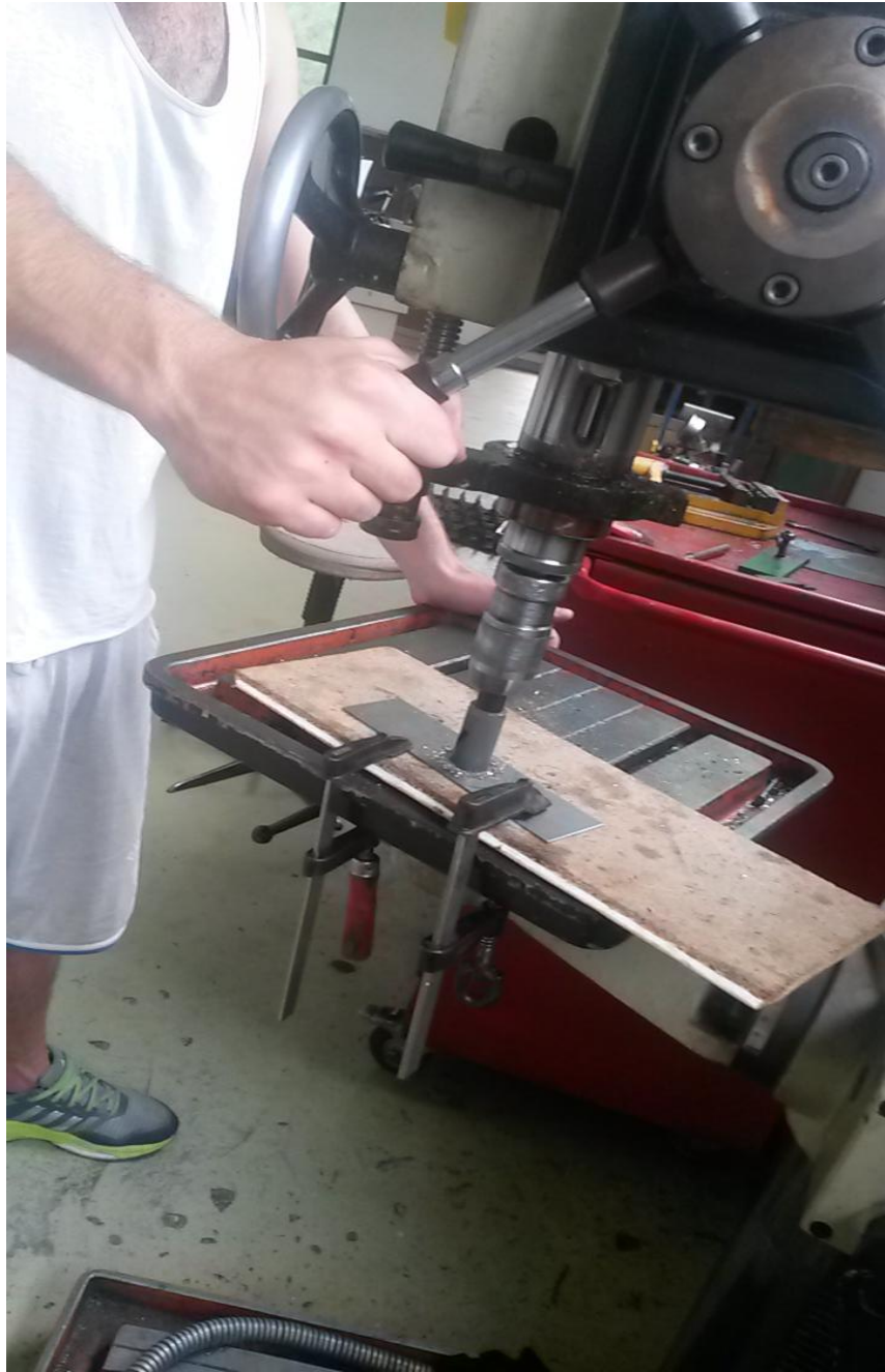
Φωτογραφία 6.2: Διάτρηση οπών ελάσματος ζυγαριάς με τη χρήση σταθερού δράπανου. Σκοπός αυτής της κατεργασίας είναι να γίνουν οι οπές στα πονταρισμένα σημεία ώστε να επιτευχθεί η συναρμολόγηση της κατασκευής με κοχλίες-περικοχλία.
