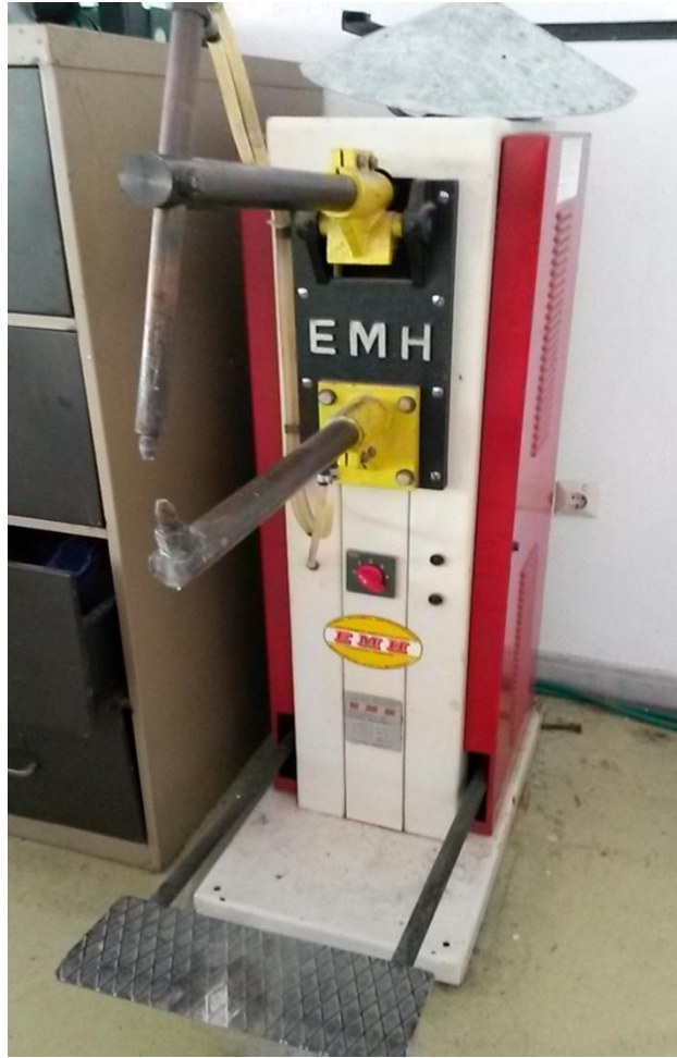
Φωτογραφία 6.6: Ηλεκτροπόντα. Ο λόγος για τον οποίο χρησιμοποιήθηκε η συγκεκριμένη εργαλειομηχανή ήταν για να συγκολληθούν μεταλλικές επιφάνειες όπως πχ στην κατασκευή (συγκόλληση μεντεσέδων με μεταλλικά ελάσματα, συγκόλληση μεταλλικού ελάσματος με καμπυλότητα με τα καπάκια φτερωτής)
