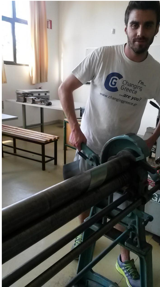
Φωτογραφία 6.4: Κατεργασία καμπυλότητας μεταλλικού ελάσματος στον κύλινδρο. Σκοπός είναι να πέτυχουμε την επιθυμητή καμπυλότητα για να κατασκευάσουμε το κουτί που θα περικλείει την φτερωτή.
