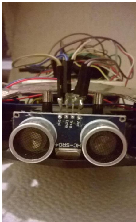
εικ 4.7 Σύνδεση των αισθητήρων με την πλακέτα Arduino
