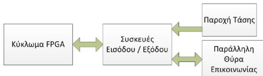
Σχήμα 4.3 Διάγραμμα βαθμίδων του αναπτυξιακού κυκλώματος LP-2900
