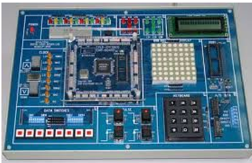
Σχήμα 4.1 Η αναπτυξιακή πλακέτα LP-2900
