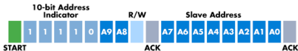
Εικόνα 4.6: Τυπικό frame 10-bit IIC διεύθυνσης.
