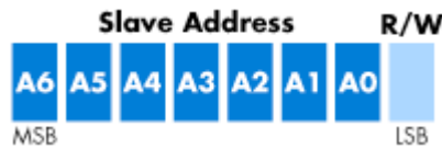
Εικόνα 4.5: Τυπικό frame IIC διεύθυνσης.
